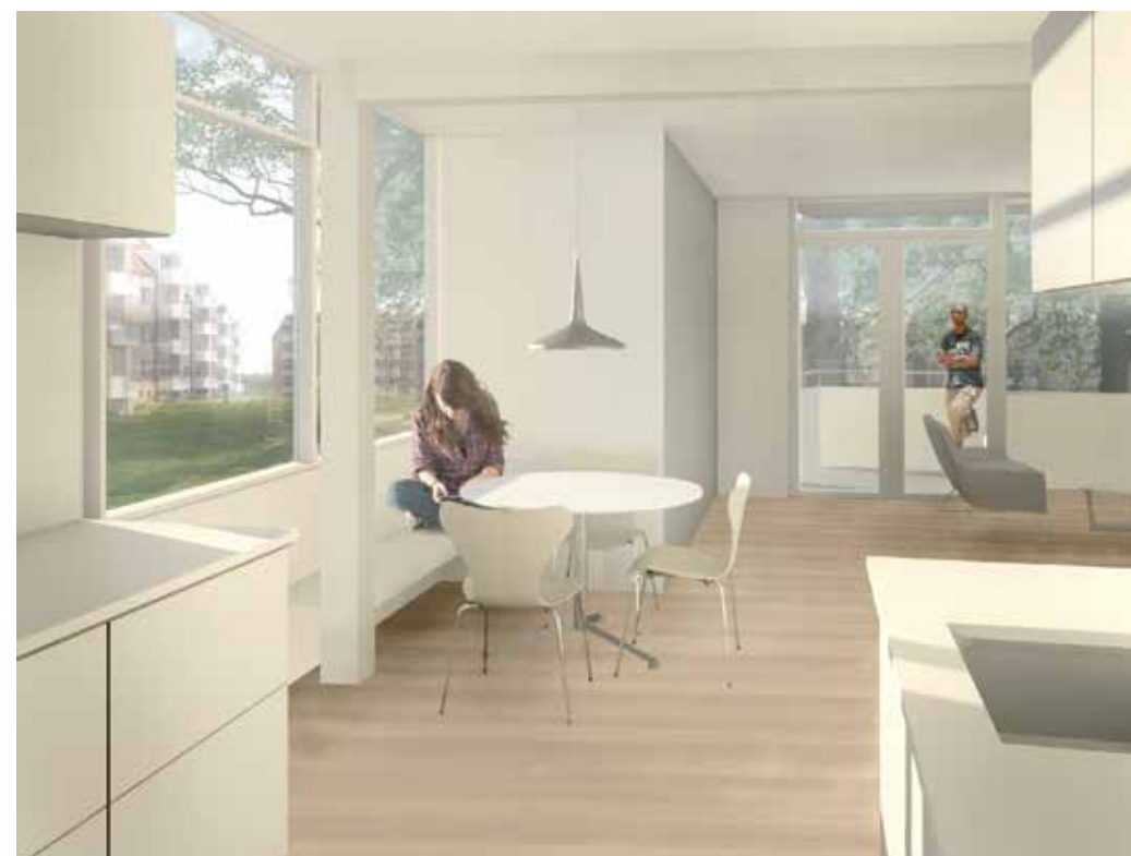
Gavllejlighed i Højstrupparken, hvor den ene altan (en lille gavlaltan) er inddraget til karnap i det nye, store køkkenalrum. Omprogrammeringen har givet lejligheden en tidssvarende rummelighed.
