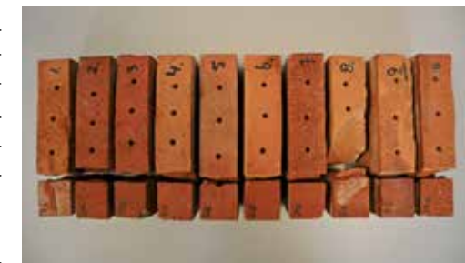
Figur 1. Sten udtaget i forbindelse med besigtigelse af boligbebyggelse fra perioden. Ud fra farven kan stenenes brændingsgrad bedømmes, og brændingstemperaturen bedømmes til at have varieret mellem ca. 850 og ca. 1050 °C. Nederst ses afhugget del af hver enkelt sten, som er genbrændt ved 1030°C. Der ses markante svind ved genbrænding, hvilket viser, at de lyseste sten har været brændt ved meget lav temperatur.
