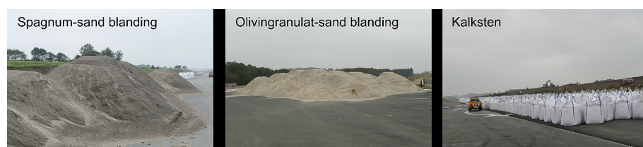
Figur 2. Filtermaterialer anvendt i anlæggene.
