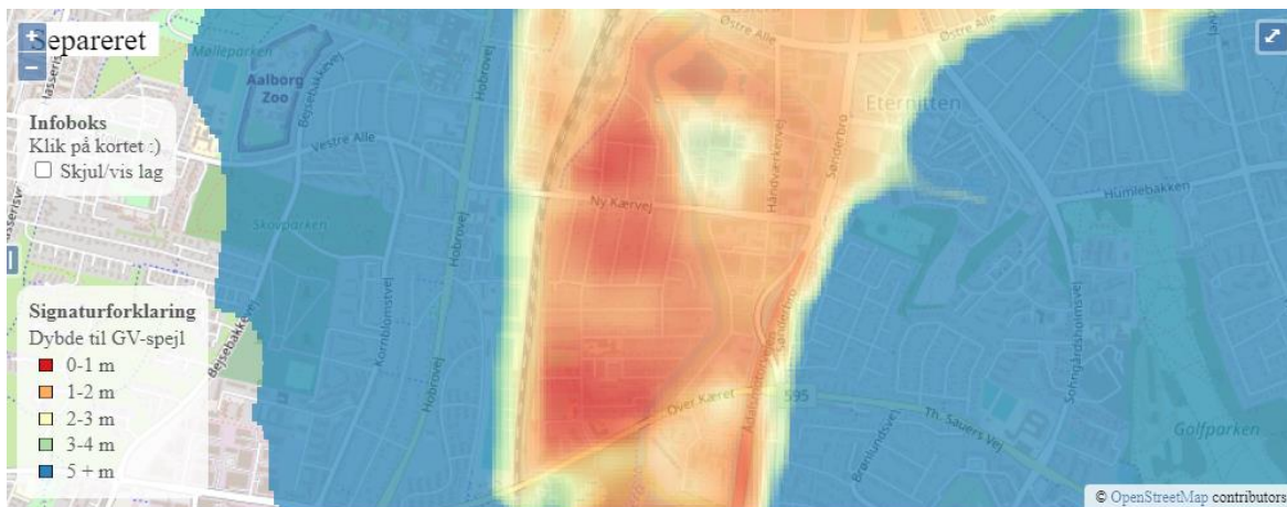
Figur 5.33: Simulering af dybden til grundvandsspejlet fra terræn for modelscenariet med separeret regn- og spildevandssystem og klimascenariet "fjern-fremtid".
