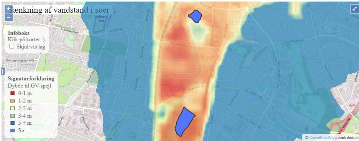
Figur 5.35: Simulering af dybden til grundvandspejlet fra terræn for modelscenariet med sænkningen af vandstand i søerne og klimascenariet "nær-fremtid".
