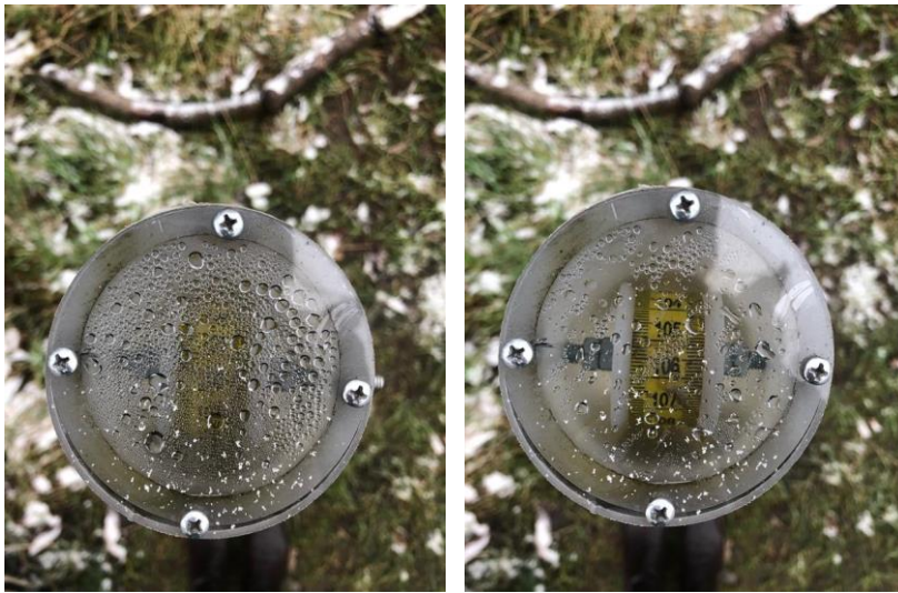
Figur 5.12: (a) Plexiglas på CS-station med kondens inden behandling med nanospray. (b) Plexiglas på CS-station med kondens efter behandling med nanospray. Aflæsningen af målebåndet er blevet tydeligere.
