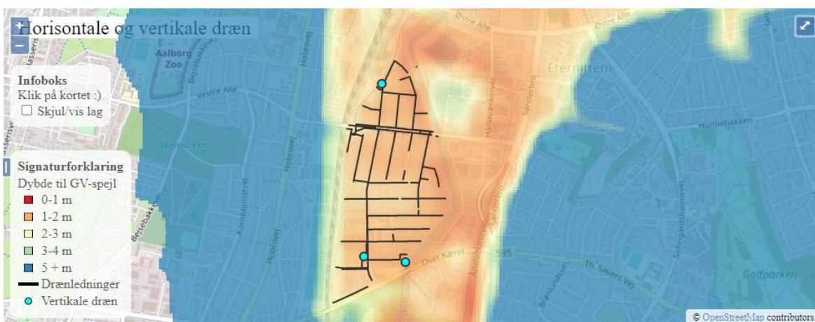
Figur 5.46: Simulering af dybden til grundvandsspejlet fra terræn for modelscenariet med horisontale og vertikale dræn og klimascenariet "fjern-fremtid".
