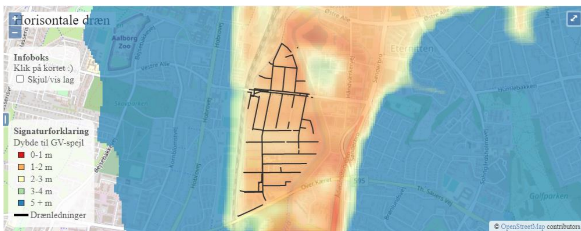
Figur 5.37: Simulering af dybden til grundvandsspejlet fra terræn for modelscenariet med horisontale drænelidninger og klimascenariet "nær-fremtid". De horisontale drænelidninger er lagt i samme tracé og dybde som det nuværende kloaksystem.
