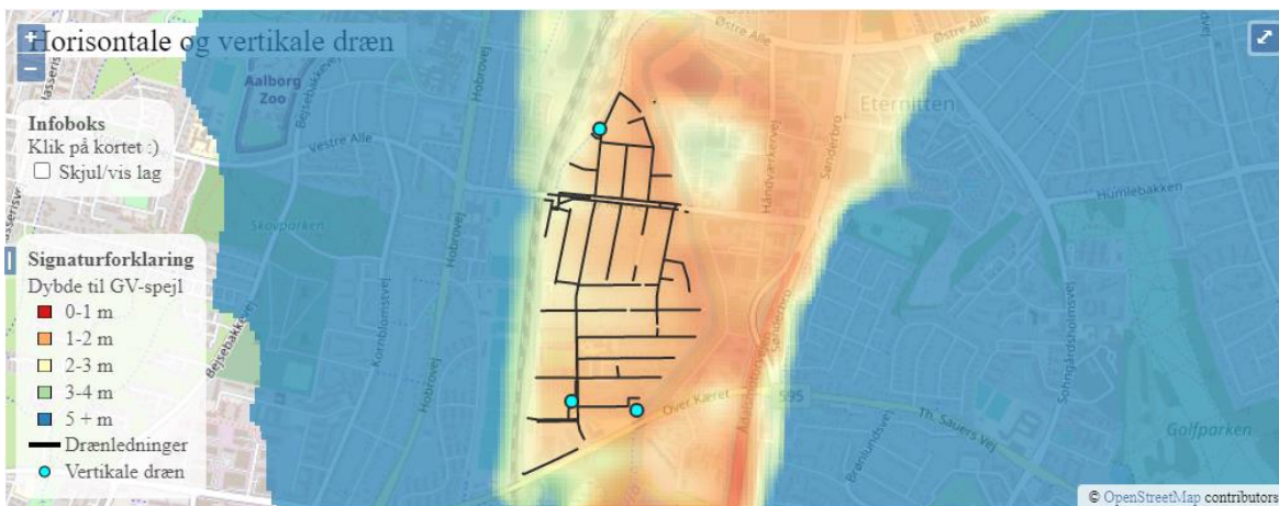
Figur 5.45: Simulering af dybden til grundvandsspejlet fra terræn for modelscenariet med horisontale og vertikale dræn og klimascenariet "nær-fremtid".
