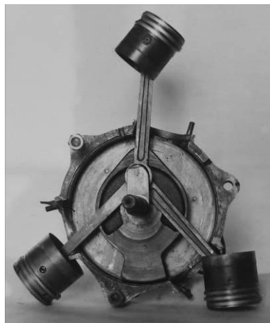
Stempler og krumtap fra Ellehammers tre-cylindrede stjernemotor. Læg mærke til ligheden med Brotherhood dampmaskinen.
