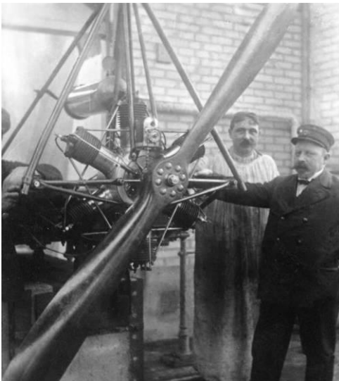
Ellehammers stjernemotor blev demonstreret i Frankrig under 1. verdenskrig. Foto: Danmarks Tekniske Museum
