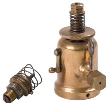
Ellehammers patenterede startventil og hans anden karburatorkonstruktion fra 1909. Sidstnævnte erstattede turbinesystemet. Foto: Danmarks Tekniske Museum
