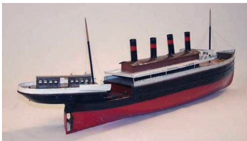
Ellehammers Titanic-inspirerede model af et skib, der deler sig i to ved sammenstød med et isbjerg e.l. Foto: Danmarks Tekniske Museum
