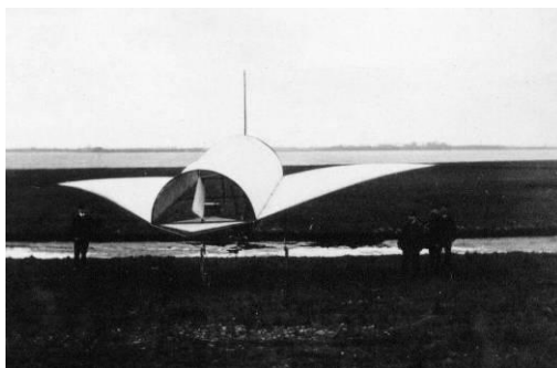
Halvcylindermodellen fra 1905. Læg mærke til masten i baggrunden. Maskinen var tøjret til den under forsøgene. Foto: Danmarks Tekniske Museum
