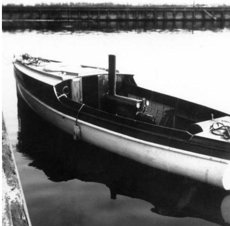
Ellehammers dampmotor indbygget i en båd. Motoren skulle bruges i fiskekuttere o.l. Foto: Danmarks Tekniske Museum
