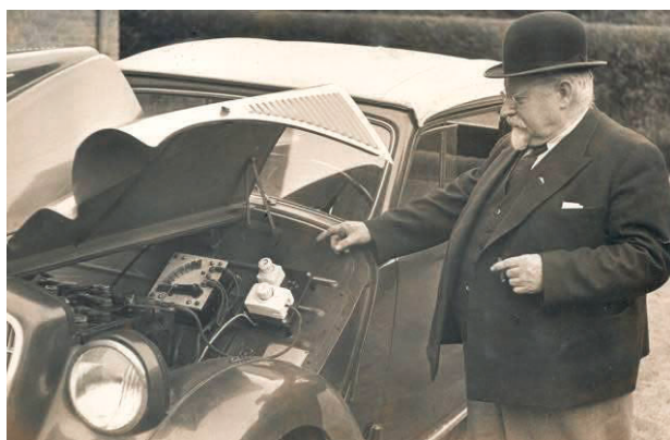
Ellehammer ombyggede under 2. verdenskrig sin bil til elektrisk drift. Foto: Danmarks Tekniske Museum
