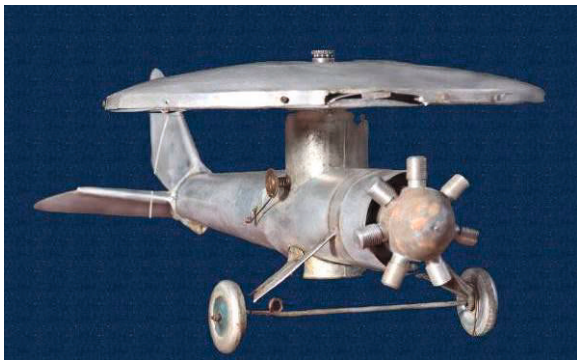
Ellehammer fremstillede mindst to modeller af en helikopter drevet af trykluft. Foto: Danmarks Tekniske Museum
