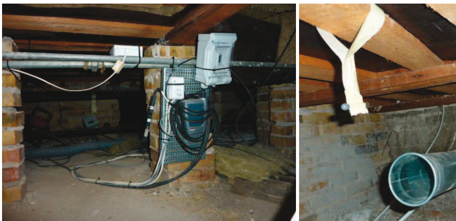
Figur 7. I krybekælderen blev der målt strømforbrug, fugt, temperatur og lufttrykdifference. På billedet til venstre ses desuden "lysdæmperen", der blev brugt til at regulere udsugningen. Endvidere blev luftopblendingen målt vha. passiv sporgasopsamling, hvor et opsamlingsrør ses på billedet til højre.
