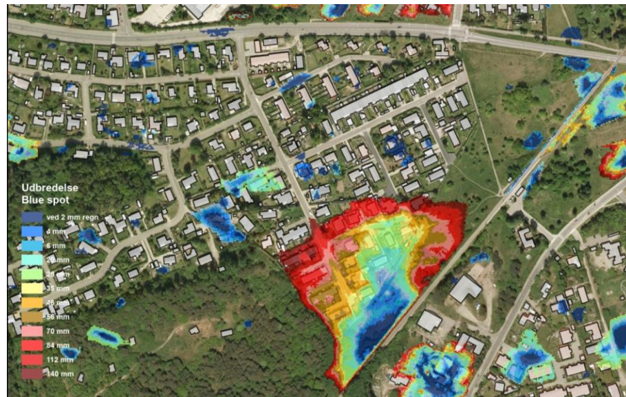
Figur 40. Eksempel på udbredelse af lavninger som funktion af nedbørsmængder – de mest udsatte områder er markeret med blåt.
