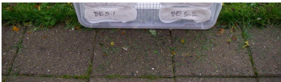
Figur 78. Betonfliser blev brugt som reference ved forsøg med simulering af regn svarende til en samlet nedbørsmængde på 20 mm (foretaget med havevander). Opsprøjtet blev målt til omkring 15 % af den indkommende nedbør i op til 170 mm højde.
