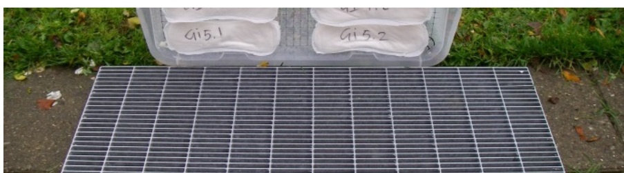
Figur 80. Simulering af regn svarende til en samlet nedbørsmængde på 20 mm (foretaget med havevander). Gitterrist lagt direkte på betonfliser reducerede opsprøjtet til omkring 6 % af den indkommende nedbør, eller ca. en tredjedel af betonflisernes værdi.
