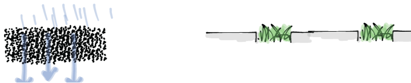
Figur 68. Belægninger med fast og jævn overflade er et krav i BR 10, og det gælder også for permeable belægninger. Græsarteringsten og fliser med store mellemrum til nedsivning som til højre er uegnede for mange med et bevægelseshandicap
