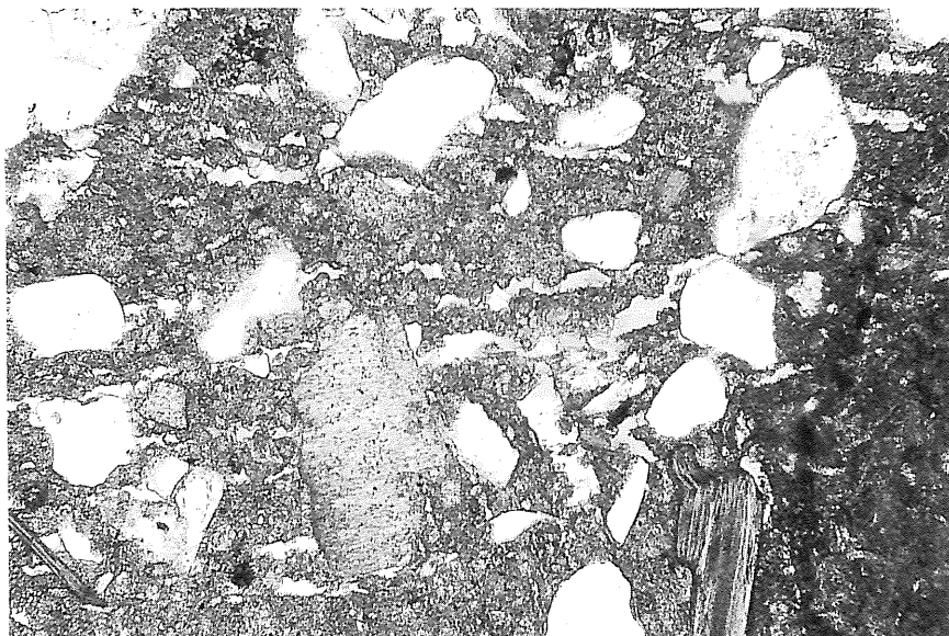
Figur 19. Typisk revnebillede i snit af beton, der har været udsat for frost før hærkning. Billedet er taget i polarisationsmikroskop med parallelle nicoller. Udsnittet er ca. 1,5 \times 1,0 mm. Foto: COWIconsult.
