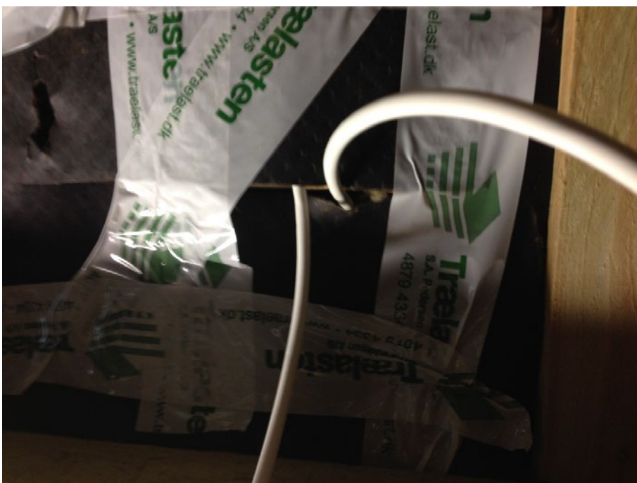
Figur 118. To fugtfølere placeret i konstruktionen uden isolering mod krybekælder. En føler er ført op i toppen af isoleringen og en er placeret lige over vindspærren mod træbjælkens bund.
