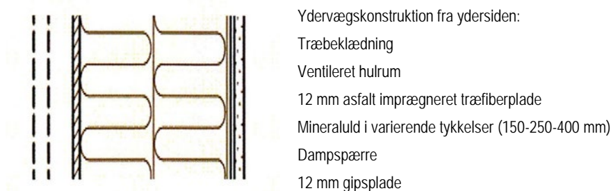
Figur 8. Konstruktionsopbygning på en let ydervæg med træskelet.
