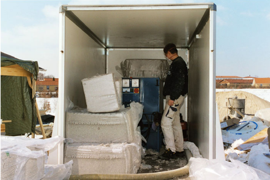
Figur 17. Maskinen som bruges til at indblæse isoleringsmaterialet ses i baggrunden. Indpakket Ekofiber, som er løsfyldisivering af cellulose, ses stabled til venstre. Det findelste isoleringsmateriale føres frem med luft i slangen nederst i billedet.
