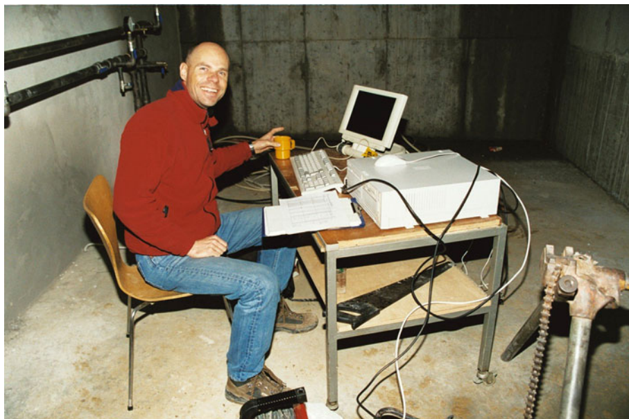
Figur 16. Det elektriske kredsløb, indeholdende alle de tilkoblede "nodes" og dermed alle målepunkterne, forbindes til en pc'er, hvor dataene opsamles. Under opbygningen af kredsløbet blev serieforbindelsen jævnlige kontrolleret og testet for fejl. Ligeledes blev kredsløbet kontrolleret for brud før, under og efter en isoleringsopgave blev gennemført.
