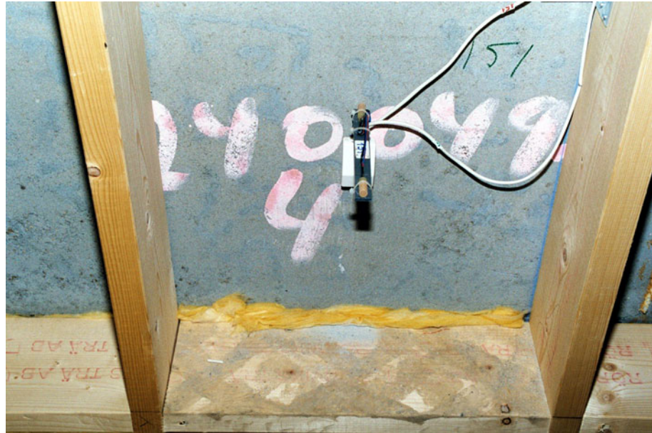
Figur 14. Pvc-vinkel med sensorer monteret på vægelement. En trædyvel og en termistor, til måling af henholdsvis fugtighed og temperatur, er placeret både mod boligen og mod vindgipsen. Trædyvlerne og termistorene er tilsluttet til en "node".
