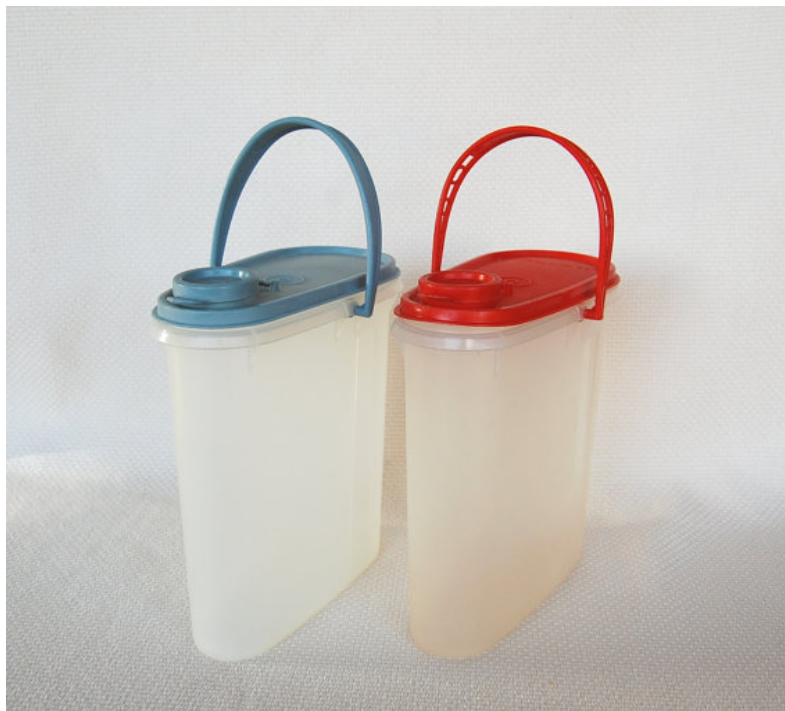
Figur 4. Beholdere fremstillet af PE kan nemt absorbere fedt, olier og farvestoffer fra mad. Den egen- skab skyldes, at PE har en åben polymerstruktur, hvor amorf, ustruktureret plads mellem polymerkæ- derne tiltrækker små molekyler, der binder sig fast. Til venstre af billedet ses en ny, ren beholder, og til højre ses en lignende beholder efter 2 år i brug. Containeren til højre har absorberet fedt og olier fra den mad, som har været opbevaret i beholderen (Shashoua, 2008).
