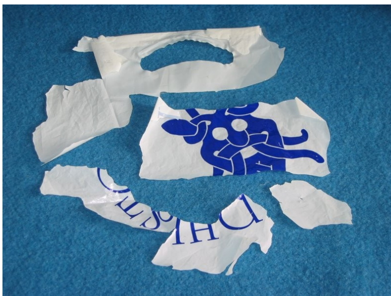
Figur 6. PE-bæreposen eksponeret for sollys og oxygen i 12 måneder er disintegreret, fordi polymerkæden er knækket pga. UV-lysets energi. Posen kan ikke længere anvendes som en pose.
