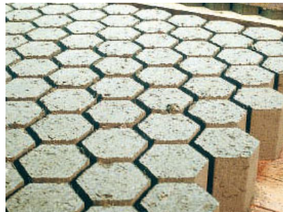
Figur 5. Her vises et billede af de genbrugsbriketter, som benyttes ved produktionen af Rockwool isolering.
