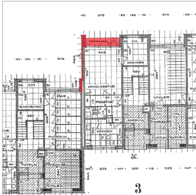
Figur 3. Plan af vægge og dæk med markering (rødt) af bærende konstruktionsdele, som fjernes i forbindelse med renoveringen (Blennum, Gjøderum & Jørgensen, 1957).
