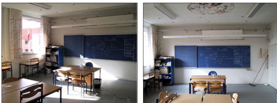
Figur 12. Parkskolen. Lokalet er velbelyst med en god kontrastfordeling og kun en smule himmelblænding. Orienteringen mod syd bevirker, at der er behov for solafskærmning. Dette har man valgt at løse med et udvendigt lameludhæng samt indvendige gardiner.
