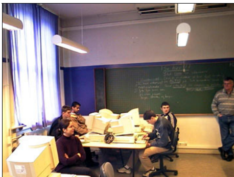
Figur 55. Hillerødsgades skole. For eleverne med synsretning mod vinduet vil vinduet give anledning til blænding og besværliggør læsning af tekster på skærm og på papir. Når hoved og øjne flyttes fra lysere (vindue) til mørkere områder (skærm og tavle) eller omvendt, vil øjet automatisk tilpasse sig synsfeltets luminans, men hyppige skift mellem høje og lave niveauer trætter øjet. For eleverne, der sidder med ryggen mod vinduet, vil vinduet give generende spejlinger i skærmen, selvom gardinet er trukket for.
