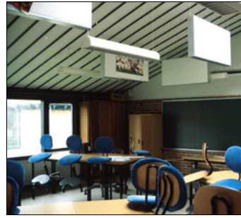
Figur 23. Solvangsskolen. Kombinationen af sidelys og ovenlys giver rigeligt med lys i klasselokalerne, men på grund af farve- og materialevalg opleves områder alligevel dunkle.
