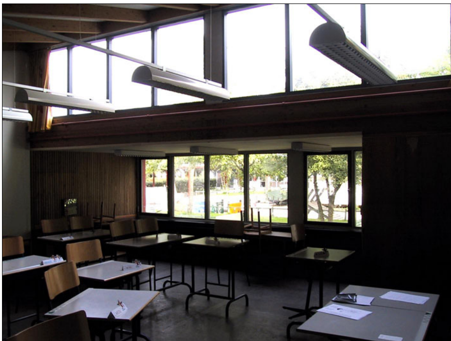
Figur 58. Lokale før renoveringen. Lokalet får dagslys fra to gennemgående vinduesbånd, et med udsigt til skolegården, og den høje del af lokalet desuden modtager dagslys fra et stort højtstående vinduesparti placeret over nichen. Træbeklædningen i den lavere del stjæler en del af reflekslyset, og det samme gør sig gældende for loftet i det store rum, hvor man med fordel kunne udnytte den skrånende flade til at reflektere lyset tilbage på vinduespartiet for at dæmpe kontrasten. De mørke vinduesrammer skaber også, især i de højtstående vinduer, unødige kontrastproblemer.
