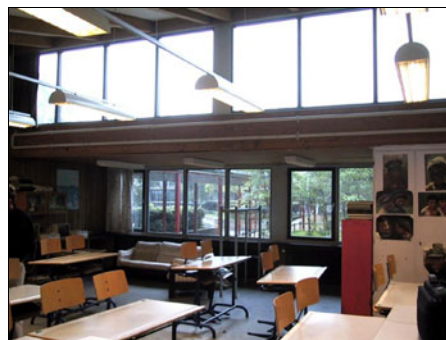
Figur 25. Tingbjerg skole. Den lavere del får dagslys fra et gennemgående vinduesbånd med udsigt til skolegården, mens det største areal hovedsageligt får dagslys fra et stort, højsiddende vinduesparti, placeret over nichen.
