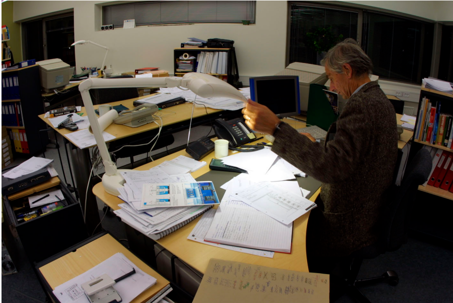
Figur 6. En asymmetrisklysende arbejdslampe kan, med sin præcise lysstyring, sikre tilstrækkeligt ekstra lys på manuskriptet på bordet uden generende reflekser på dataskærmen.
