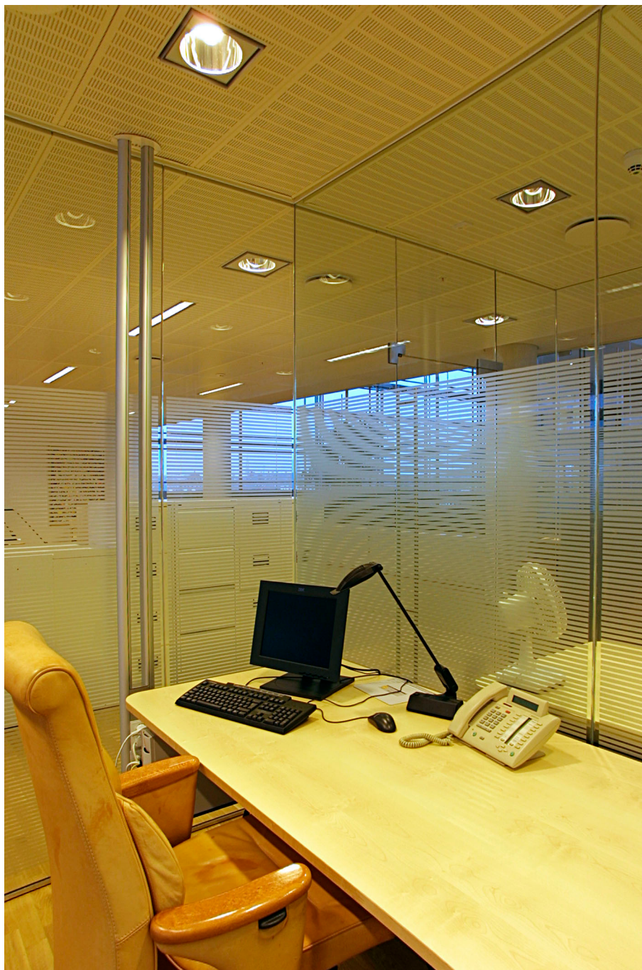
Figur 18. Placeringen af arbejdspladser i forhold til både kunstlyset og dagslyset er meget vigtig for at undgå generende blænding.
