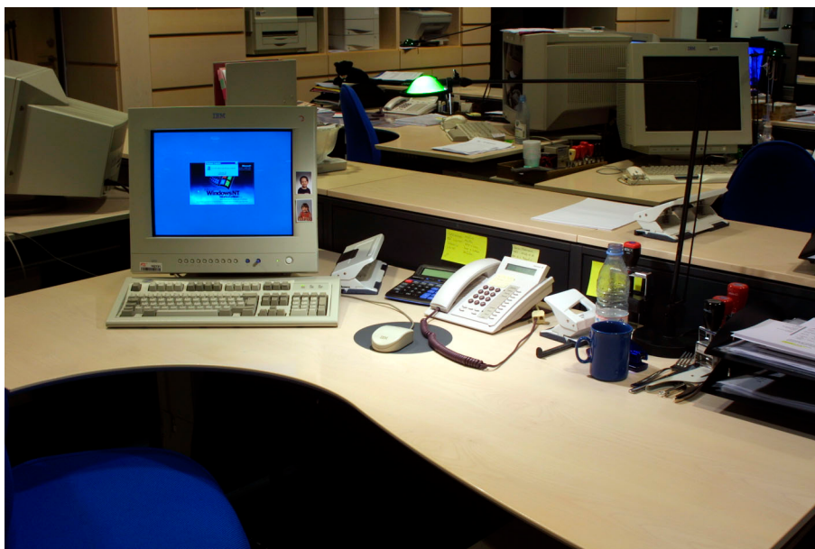
Figur 41. Om aftenen er de små grønne arbejdslamper hvide indeni, og halogenpærerne er matte, så lyset fra dem går an, hvis det bare ikke spejler sig i bord m.m.
