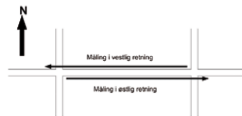
Figur 2. Principskitse for måling af rejsetid i de enkelte segmenter i hver retning.
