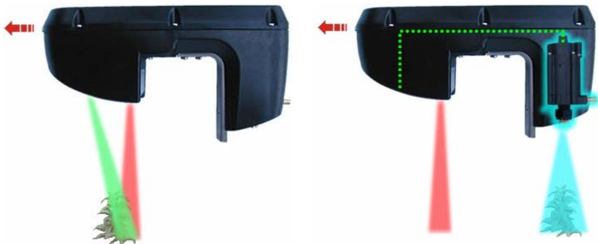
Figur 2. WeekSeeker konceptet. En infrarød lyskilde (rød) belyser jordoverfladen i bånd på 30 cm. En optisk sensor detekterer reflekteret infrarødt lys fra grønt plantemateriale og med en forsinkelse tilpasset fremdriftshastigheden aktiveres sprøjtedysen ( www.greenseeker.com ).
