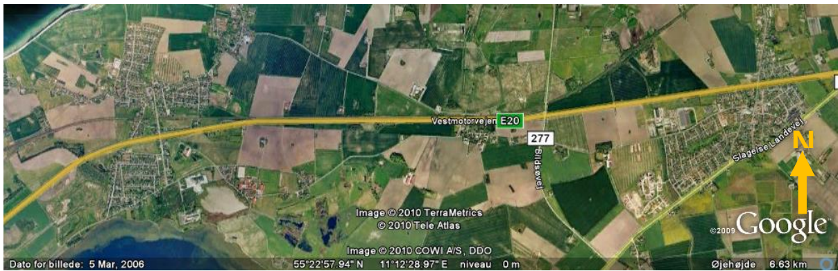
Figur 34. Strækning af en af de ældste danske motorveje, nemlig E20 – Vestmotorvejen mellem Halsskov (Korsør) og Slagelse. Strækningen er opbygget af rette linjestykker, hvorimellem der er indlagt kurver med forholdsvis små horisontalradier. Billede fra Google Earth.
