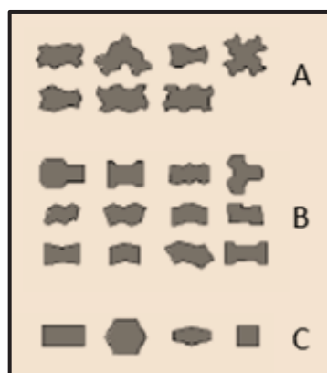
Figur 32. Eksempler på forskellige typer betonbelægningssten. Alle tre typer kan anvendes ved trafikklasse T0 og T1. Ved trafikklasse T2, kan type A og type B anvendes; mens alene type A bør anvendes ved trafikklasse T4 og T5. Efter (Vejdirektoratet, 2013).
