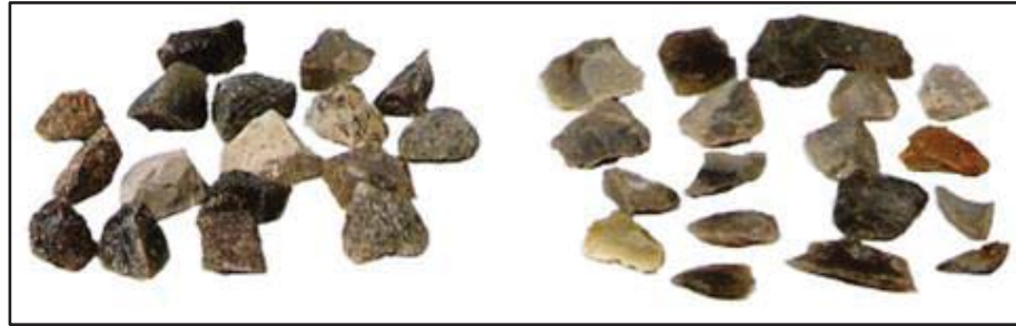
Figur 23. Til venstre kubiske sten med flisethedstal f = 1,20 . Til højre flisede sten med flisethedstal f = 1,45 . Fra (Larsen & Dybdal, 2013).
