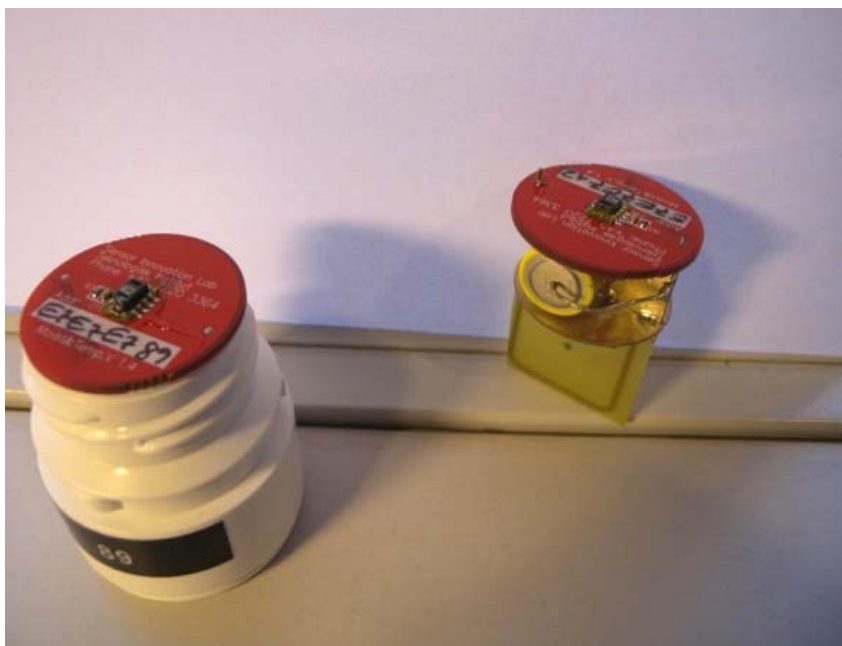
Figur 2. Den anvendte, lukkede indkapsling ('pilleglas') uden låg.
