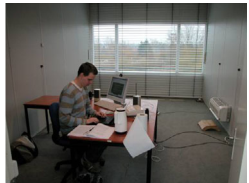
Figur 6. Opsætning i testrum og referencerum. Arbejdspladsen var indrettet således at forsøgspersonen var drejet 45° væk fra vinduet ved arbejde på SBI's pc. Ved arbejde ved egen pc eller andet arbejde sad forsøgspersonen parallelt med vinduet (som vist på foto).
