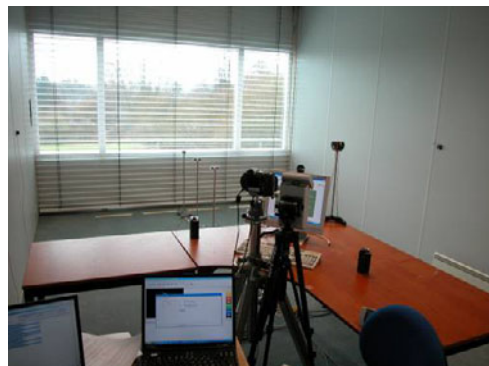
Figur 6. Opsætning i testrum og referencerum. Arbejdspladsen var indrettet således at forsøgspersonen var drejet 45° væk fra vinduet ved arbejde på SBI's pc. Ved arbejde ved egen pc eller andet arbejde sad forsøgspersonen parallelt med vinduet (som vist på foto).
