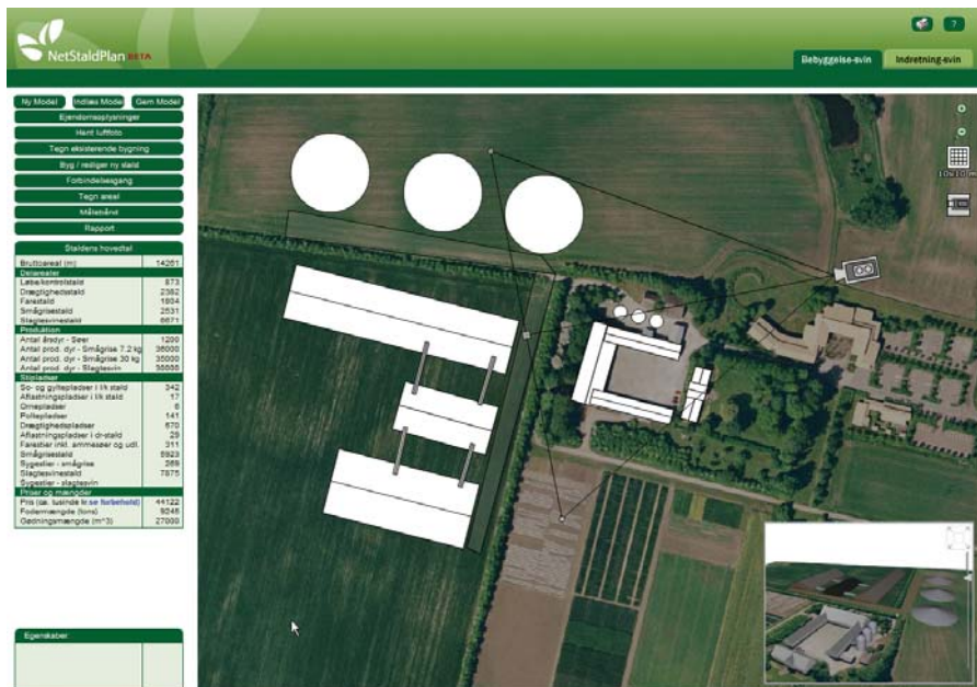
Figur 1. Det store overblik over bygningerne fås i 2D GIS med ortofoto. 3D-modellen bidrager med det visuelle indtryk af staldanlægget.
