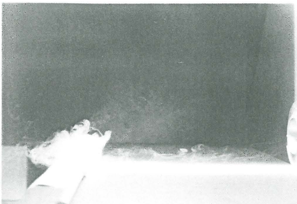
Figur 17. Udsugning i bagvæg ved bord 5 sekunder efter, at en person er gået forbi bordet. V_u = 300 \text{ m}^3/\text{h} .
