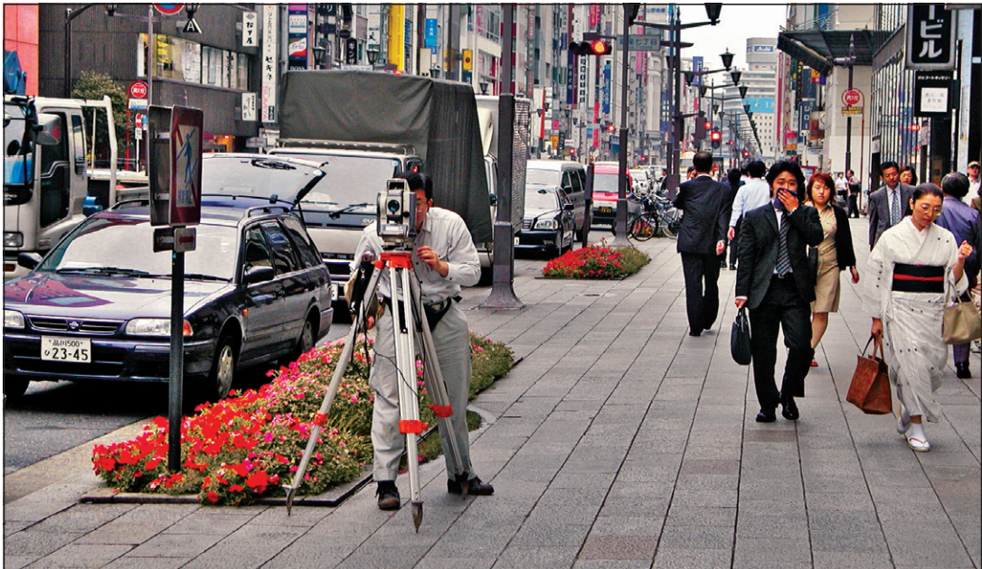
Figura 12.15 Un agrimensor usa un teodolito digital para una inspección catastral en Tokio, Japón.
