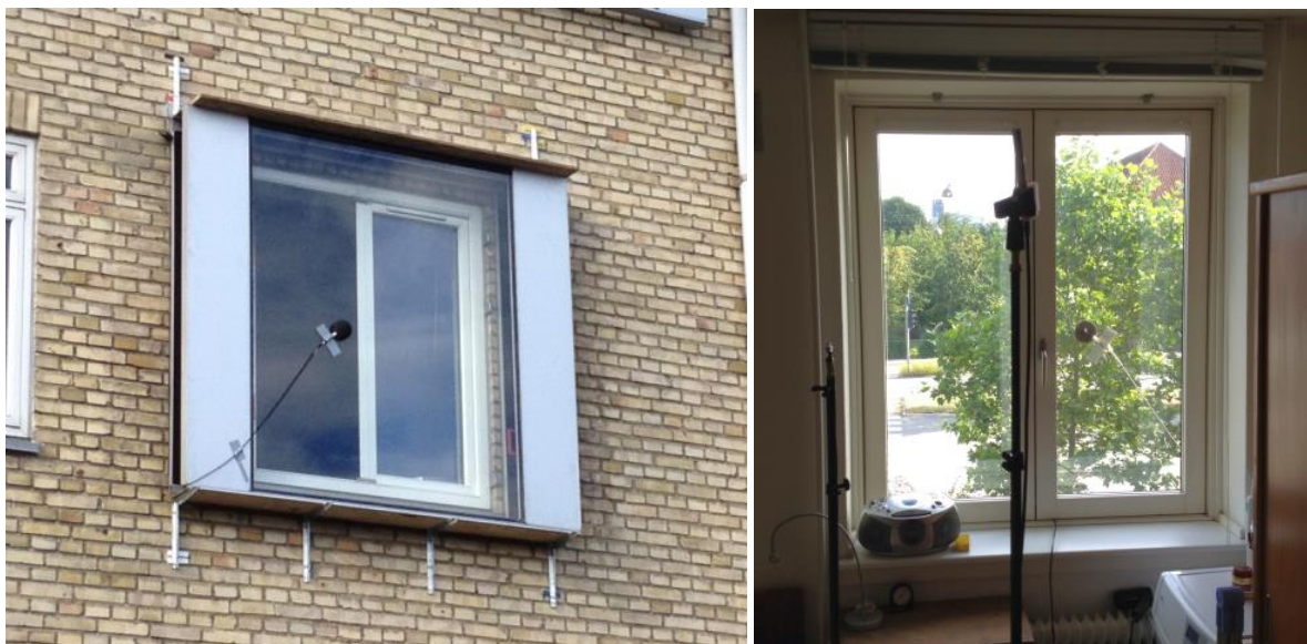
Den udvendige målemikrofon set fra Folehaven (udrykket lydskodde) og fra målerummet.
