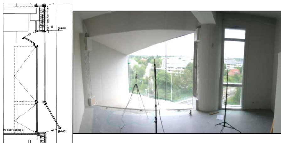
Figur E.2. Snittegning af russervindue er vist til venstre. Fotoet af facaden set indefra viser det faste vindue til venstre, og til højre i billedet det oplukkelige vindue. Tegning og foto fra målerapport [E1].
