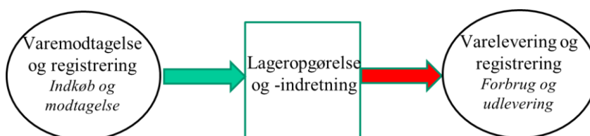
FIGUR 24. Grundprincip for lagerstyring med varemottagelse, lagerindretning og varelevering samt registrering og opgørelse, hvor spild og svind opgøres.
