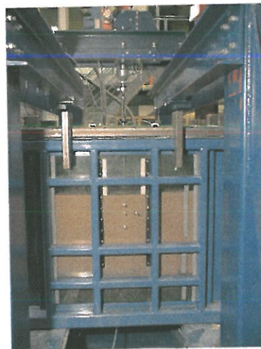
Figur 1. Forsøgsopstilling til sugebøttefundamenter monteret i den cykliske opstilling efter Leth og Mikkelsen (1998).
