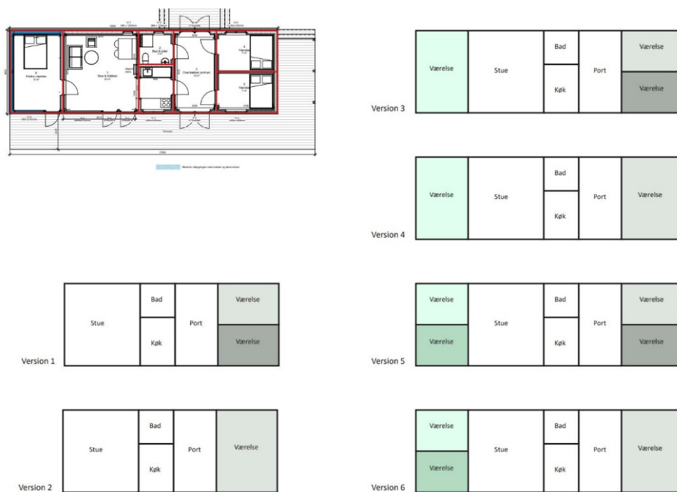
FIGUR 12. Modulhusene er bygget på grundlag af det såkaldte Mønhuset, der kan organiseres med forskellig indretning, fx som vist i de 6 versioner. [Vordingborg, A13].
