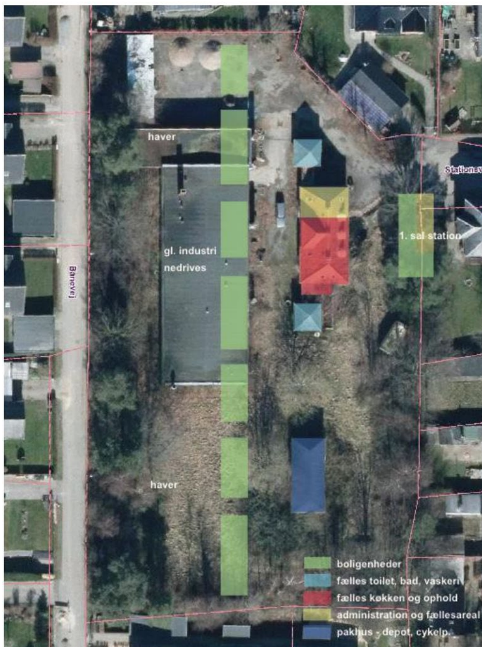
FIGUR 10. Luffotoet er fra ansøgningsmaterialet til BPST og viser grundens afgrænsning, de eksisterende bygninger og den fremtidige udnyttelse af grunden til 6 nye modulhuse. [Vordingborg, A1].
