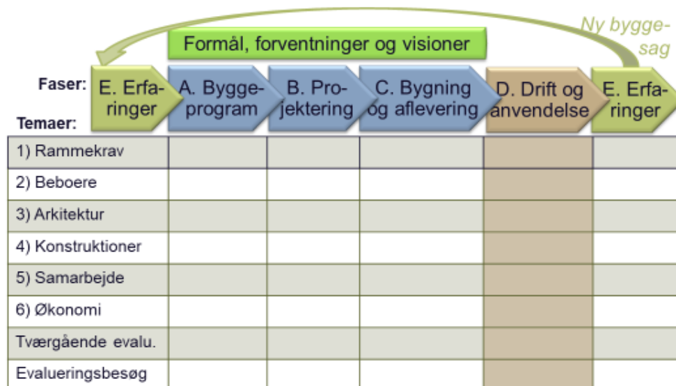
FIGUR 2. Model for evaluering: Evalueringen gennemføres i tre lodrette delevalueringer parallelt med faserne A, B og C i modulforsøgene og byggesagerne, og evalueringen sammendrages i fase E, hvor erfaringerne kan formidles til nye byggesager og forsøg. Modellen og hvert af dens seks gennemgående evalueringstemaer (temaerne 1-6) bygger bl.a. på en egenevaluering, som gennemføres af de enkelte udviklingsteams. Byggefase D, 'Drift og anvendelse', indgår ikke i evalueringen.
