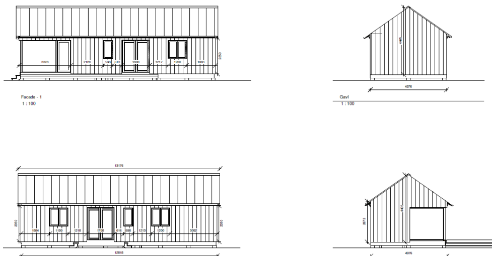
FIGUR 8. Opstalt af modulhus 1, som er 5,0 m bredt, 15,8 m langt og med et bruttoetageareal på 64,0 m 2 , [Vordingborg, C04].
