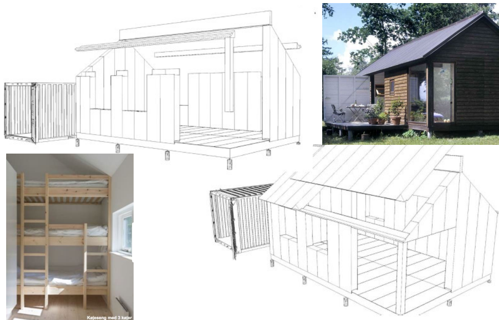
FIGUR 7. Modulhuset er en videreudvikling af Mønhuset, som er modulopbygget i industriel produktion, som kan samles på stedet i 60 brede moduler, og, hvis det ønskes, kan adskilles og flyttes til en anden placering. [Vordingborg, A01].
