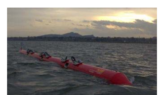
Le pelamis: des boudins semi-submergés et articulés
