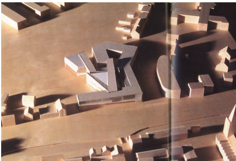
Fig. 3.54 Model i pap med papir til halvtransparente flader og plexiglas til vinduesfladerne. Modellen er sat ind i en stor model af rådhusets omgivelser i målestok 1:400/ 1.500.
