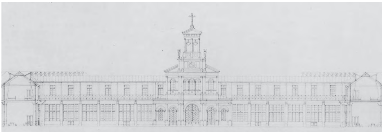
Fig. 2.32 Tværsnit fra ansøgningen med opstalt af tværflojen og kapellet, oprindeligt i mål 1:200, her gengivet i mål 1:500. Ansøgningen indeholdt derudover: En situationsplan 1:750, en 1.sals plan, en opstalt 1:200 af facaden mod rue du Faubourg Saint Antoine.
