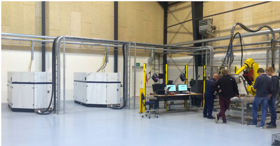
Fig. 1.5: 16 kW+16 kW disk laser unit: LWT.
