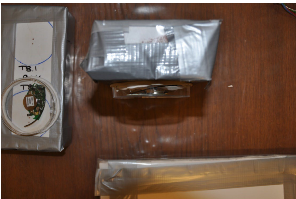
FIGUR B1.2. Foto af prøveemne på tegl med monteret fugthætte. Fugthætten overlapper gaffatape.
