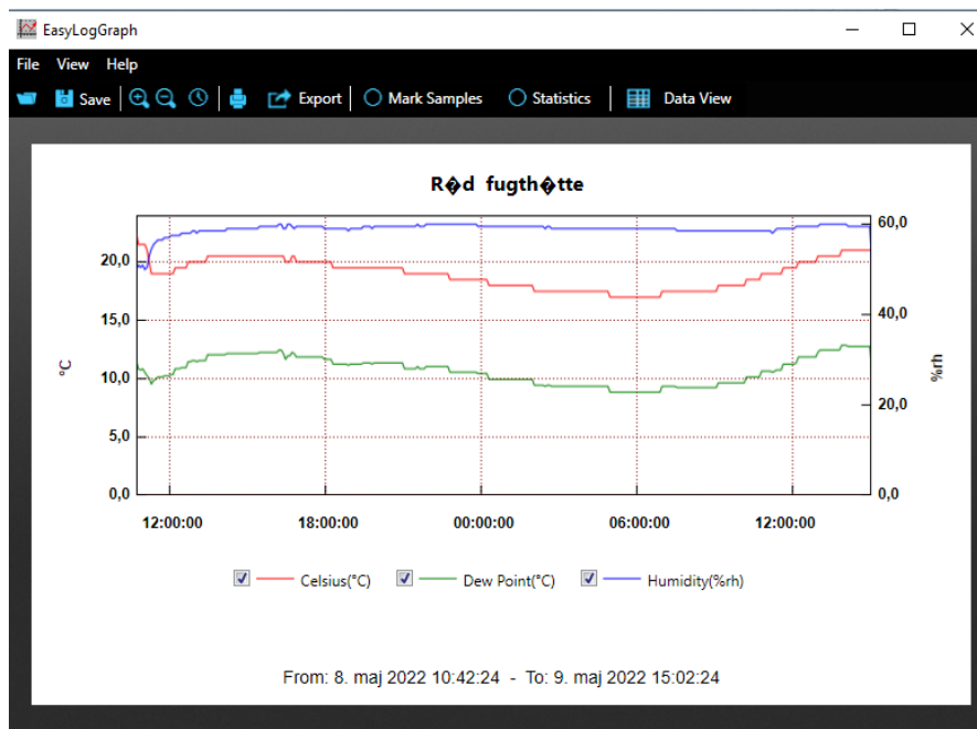
FIGUR 33. Målinger fra fugthætte monteret på letbetonvæg med puds og maling, d. 8 til 9. maj 2022.
