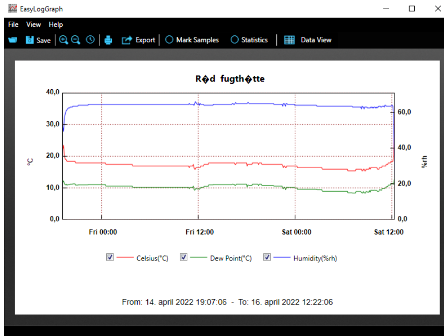
FIGUR 32. Målinger fra fugthætte monteret på letbetonvæg med puds og maling, d. 14. til 16. april.
