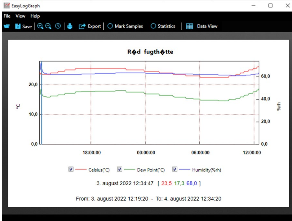
FIGUR 34. Målinger fra fugthætte monteret på letbetonvæg med puds og maling, d. 3. til 4. august. Montering markeret med lodret streg i begyndelsen af forløbet.
