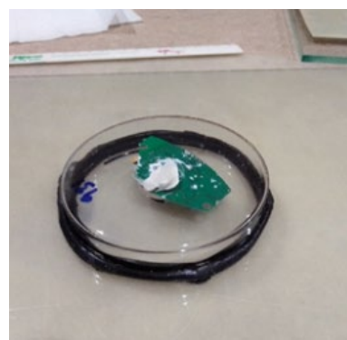
FIGUR B4.3. Tv.: Målinger af % RF i to fugthætter monteret med klæbemasse og to med bitumen på glasplader. Tidspunkt for montering er markeret. Klimakammeret er 21 °C og 75 % RH. Tallene efter materialetype er ID på de anvendte fugtmålere. Th.: foto af fugthætte monteret på glasplade med bitumen.
