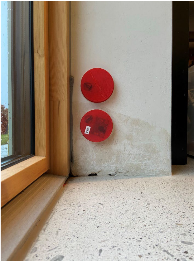
FIGUR 24. tv. Fugthætter placeret på lysning. Th. loggere måler indeklimaforhold.
