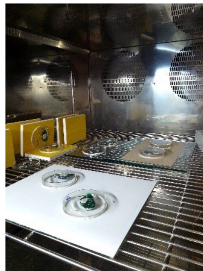
FIGUR B4.10. Målinger med fugthætter af glas på glasplade, glasplade med tapet og glasplade med malet tapet. Ændring fra 50 % RF til 75 % RF i klimakammeret d. 26.09. er markeret. Tallene efter materialetype af glashætte er ID på de anvendte fugtmålere.
