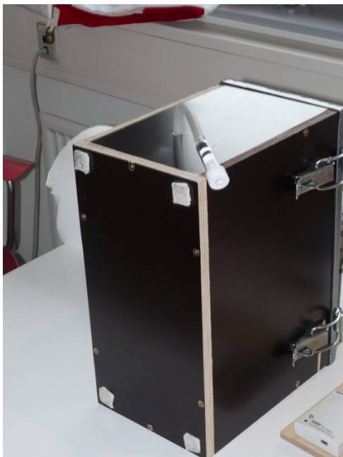
Figur 1. Opsamling af luft. Støjreducerende boks og XAD-2 opsamlingsrør.
