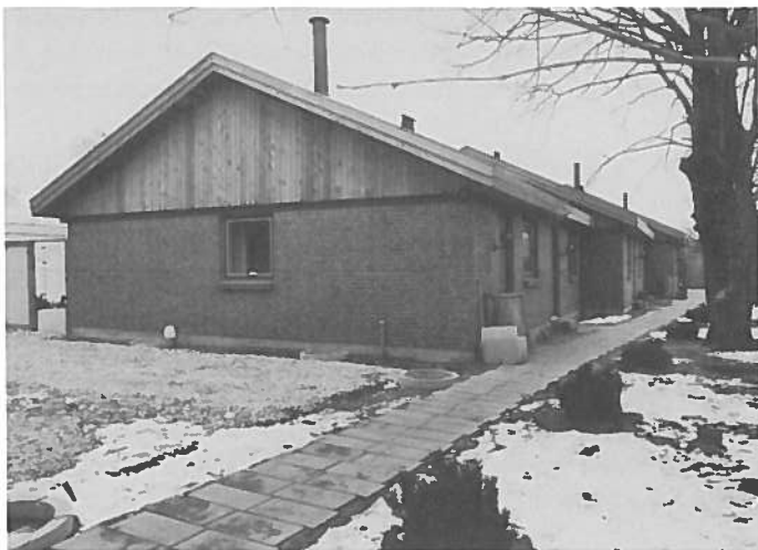
Enfamiliehuse sammenbygget i gavl med tilladelse til at udføre tagudhæng over sammenbygningsskellet.
