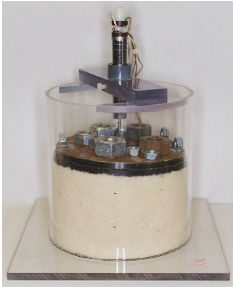
Figur 6. Apparat til måling af momentantøjning samt krybning. I det viste tilfælde er Thermocell med en densitet på 40 \text{ kg/m}^3 påsat en vertikal belastning på 499 \text{ Pa} .
