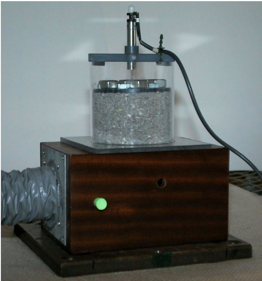
Figur 7. Apparatur til måling af krybningen ved cyklisk varierende relativ luftfugtighed. I det viste tilfælde er Ekofiber med en densitet på 50 \text{ kg/m}^3 påsat en vertikal belastning på 123 \text{ Pa} + 21 \text{ Pa} . Den vertikale last på oversiden af isoleringen er 123 \text{ Pa} , og trykket på undersiden af isoleringen er 21 \text{ Pa} .
