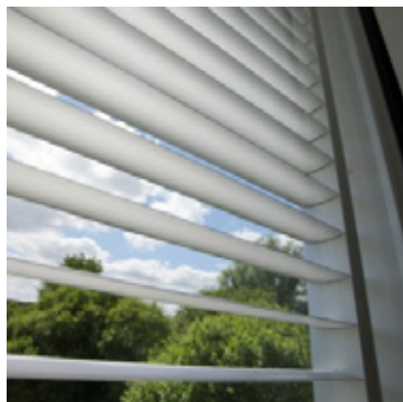
Figur 28. Lamelbaseret ramme afprøvet i SBI's dagslyslaboratorium i Hørsholm.
