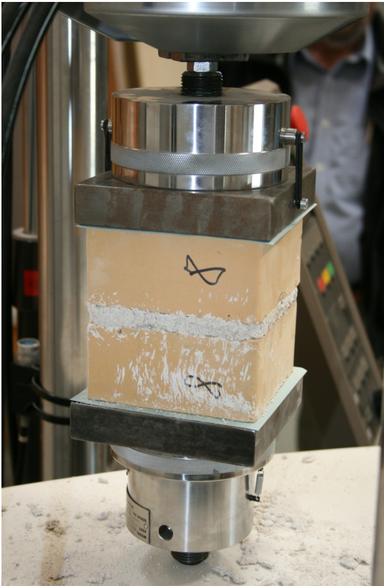
Figur 1.1. Lastopstilling. Totale deformationer registreres.
