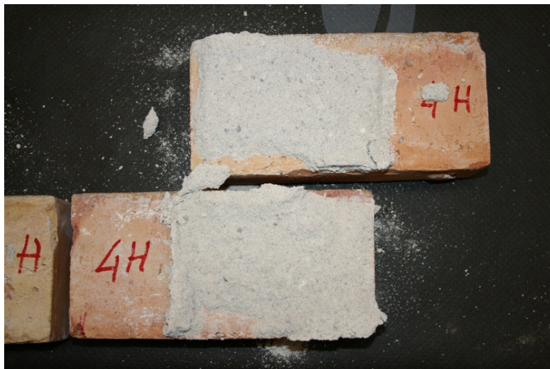
Figur 8. Fotografi af mørtelbrud i forsøgsemne 4H.
