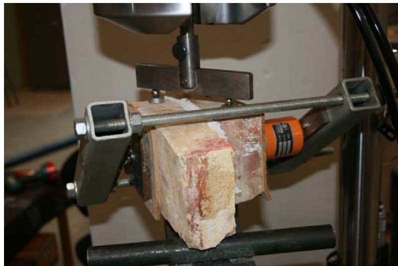
Figur 5. Forsøgsopstilling til bestemmelse af forskydningsstyrken af kalkmørtelfuger.
