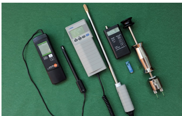
Figur 8. Forskellige modeller af målere til måling af fugt i borehuller mv. Th. en nyt typer udstyr hvor der kan anvendes flere forskellige følere på samme instrument; her vist med føler til borehuller (den blå) og isolerede stikben (længst til højre). Ved måling i borehuller kan der anvendes flere følerhoveder, som kan efterlades, indtil der er opnået ligevægt, mens instrumentet i mellemtiden kan anvendes til andre formål (Brandt, 2013).
