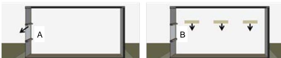
Figur 5. Placering af lysfølere i de to systemer, open-loop i rum A og closed-loop i rum B.
