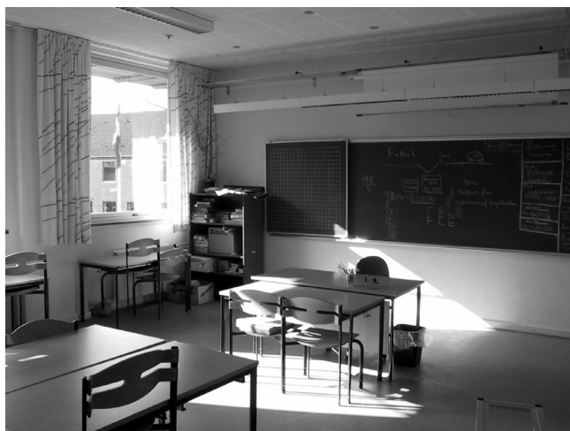
Figur 4.2. Skole G. Lokalet er velbelyst med en god kontrastfordeling og kun en smule himmelblænding. Orienteringen mod syd bevirker, at der er behov for solafskærmning. Dette har man valgt at løse med et udvendigt lameludhæng samt indvendige gardiner. Normalt er permanent solafskærmning ikke hensigtsmæssig i Danmark, hvor vi har gråvejrs 2/3 af tiden, men i dette tilfælde er udhænget med til at afhjælpe blændingsgener fra himlen og udjævne lysfordelingen ind gennem rummet. Anvendelse af indvendige persienner eller rullegardiner i stedet for de nuværende gardiner ville give en større lysmæssig fleksibilitet, idet de giver bedre mulighed for delvis afskærmning.
