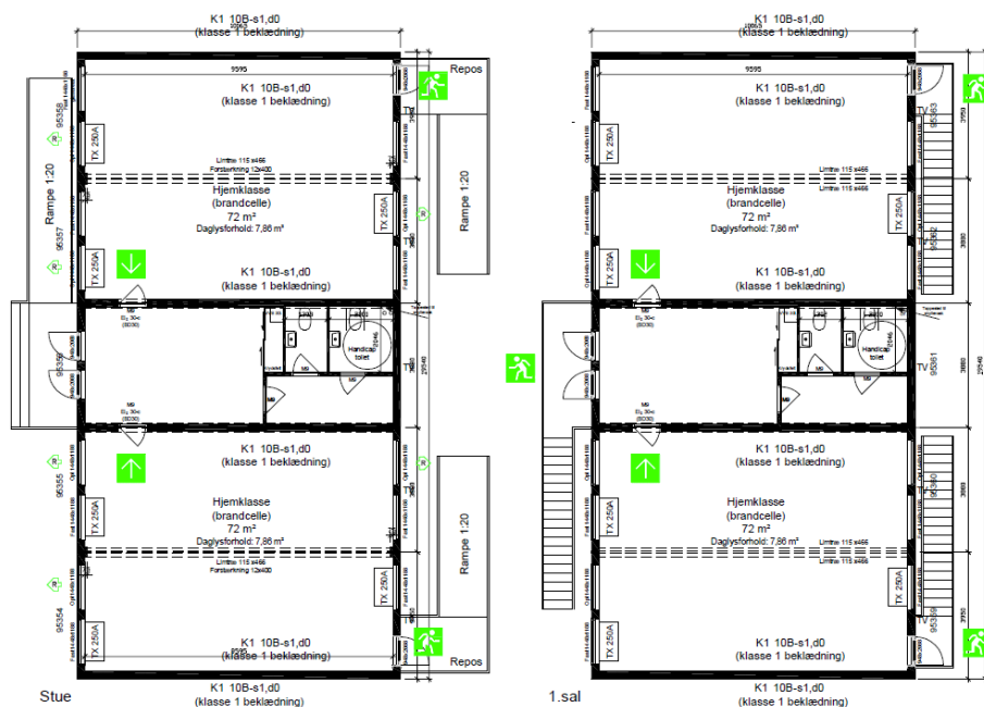
Figur 5. Plantegning. Institutionsbyggeri bestående af 10 pavillonmoduler i 2 etager.
