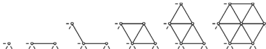
Figur 89. Princippet i et successivt opbygget rumligt stabilt stangsystem. Den første knude understøttes i tre retninger, derefter tilføjes knude efter knude, således at hver knude, der tilføjes, fastholdes i tre retninger, enten af stænger fra eksisterende knuder, eller af nye understøtninger eller af en kombination heraf. En understøtning er vist med en kort streg, der angiver den retning, hvori knuden er fastholdt.
