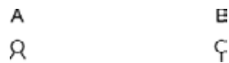
Figur 72. A Knude, der er fastholdt i planen, og B knude, der er fastholdt i een retning.
