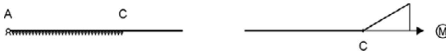
Figur 80. Tynd bjælke, der er udkræget fra punkt C og ud. Systemet er stabilt, men der opstår væsentlige bøjningskræfter, når systemet belastes udenfor C.
