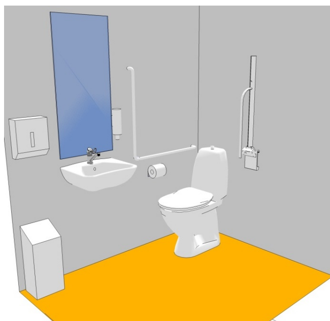
Figur 8: Eksempel på indretning efter MSC Circ. 735. Vendeplads for kørestolsbrugere bliver i dette tilfælde for lille. Ved denne model anbefales fastmonteret armstøtte som vist på figuren. Et fåtal af kørestolsbrugere vil kunne anvende toilettet som skitseret. Det er yderst vigtigt, at hele det viste gulvareal er frit. Man må således fx ikke optage noget af det med en evt. reces fra et tilstødende rum.
