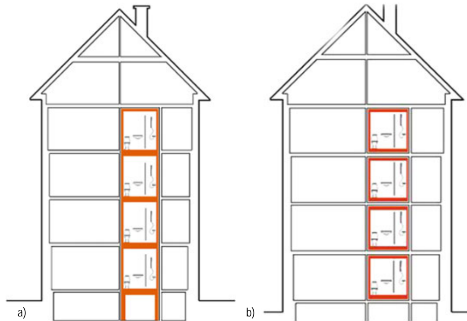
Figur 5. a) Selvbærende tårn af kabiner med nyt, selvstændigt fundament i kælderen. b) Selvstændige badeværelsesceller i hver lejlighed installeret på etageadskillelse i form af træbjælkelag.
