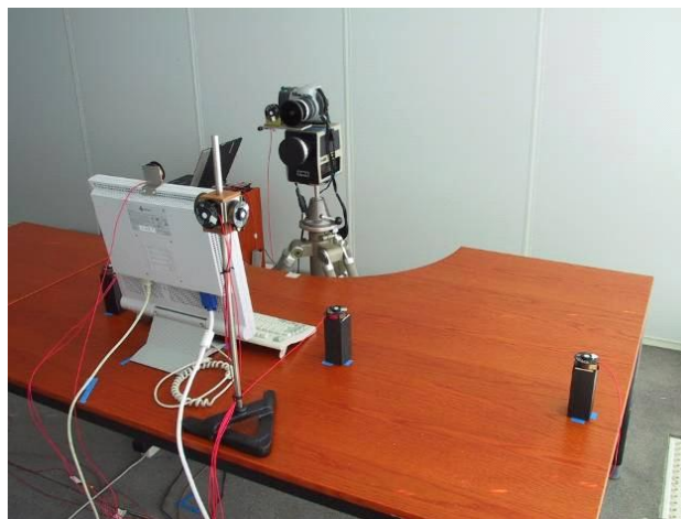
Figur 61. Måleopstilling i målerum med CCD kamera placeret svarende til forsøgspersonens øjenplacering i forsøgsrummet. Persennejusteringer og ændringer på pc-skærmen følger slavisk ændringer i rummet, hvor forsøgspersonen er placeret.
