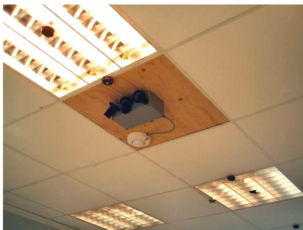
Figur 28. Prototype af sensor bestående af 3 Hagner SD2 belysningsensorer (se også figur 58). Hver sensor er afskærmet med et kvadratisk rør, således at de måler henholdsvis 1 m 2 på væg og 2 m 2 på bord. Den hvide sensor er en tilstedeværelsessensor.
