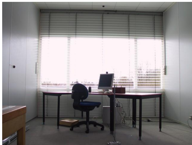
Figur 60. Eksempel på forsøgsopstilling ved middelstort vindue i SBI's Dagslyslaboratorium. Her er forsøgspersonens placeret således at synsretningen er skråt mod vinduet i en vinkel på ca. 45 grader. Forsøg med en placering, hvor forsøgspersonen synsretning var parallel med vinduet blev også undersøgt.
