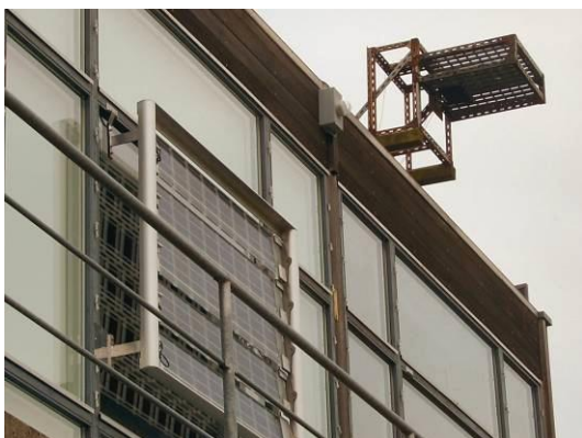
Figur 29. Afprøvning i SBI's Dagslyslaboratorium. Systemet var planlagt afprøvet for almindelige udvendige persienner og for drejelige lameller med integrerede solceller. På taget af laboratoriet ses instrumenter til registrering af indstråling.
