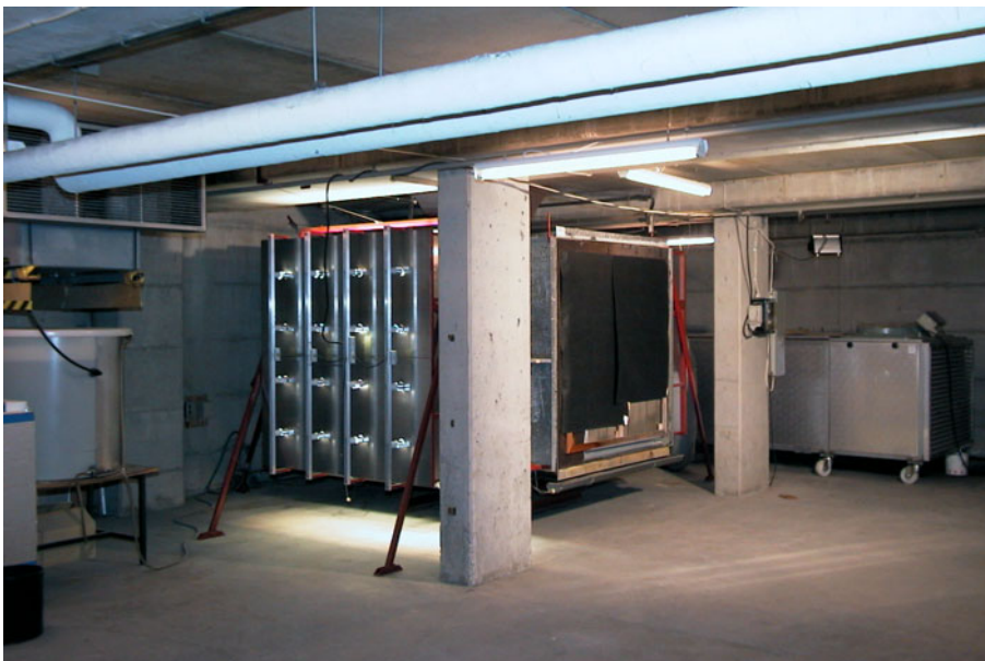
Figur 3. Foto af "De fire årstider" der fra venstre viser vandtank med 280 l demineraliseret vand til regnfasen, klimakassen med 16 ULTRAVITALUX lamper, karruselsiden med prøveemner (her et undertagsmateriale) der befinder sig i optøningsfasen ved almindeligt laboratorieklima og den fritstående kølemaskine. Når der skal ske drejning ved faseskift trækkes og vippes de tre klimakasser ud fra karrusellen, der så kan dreje en kvart omgang omkring sin midtersøjle.
