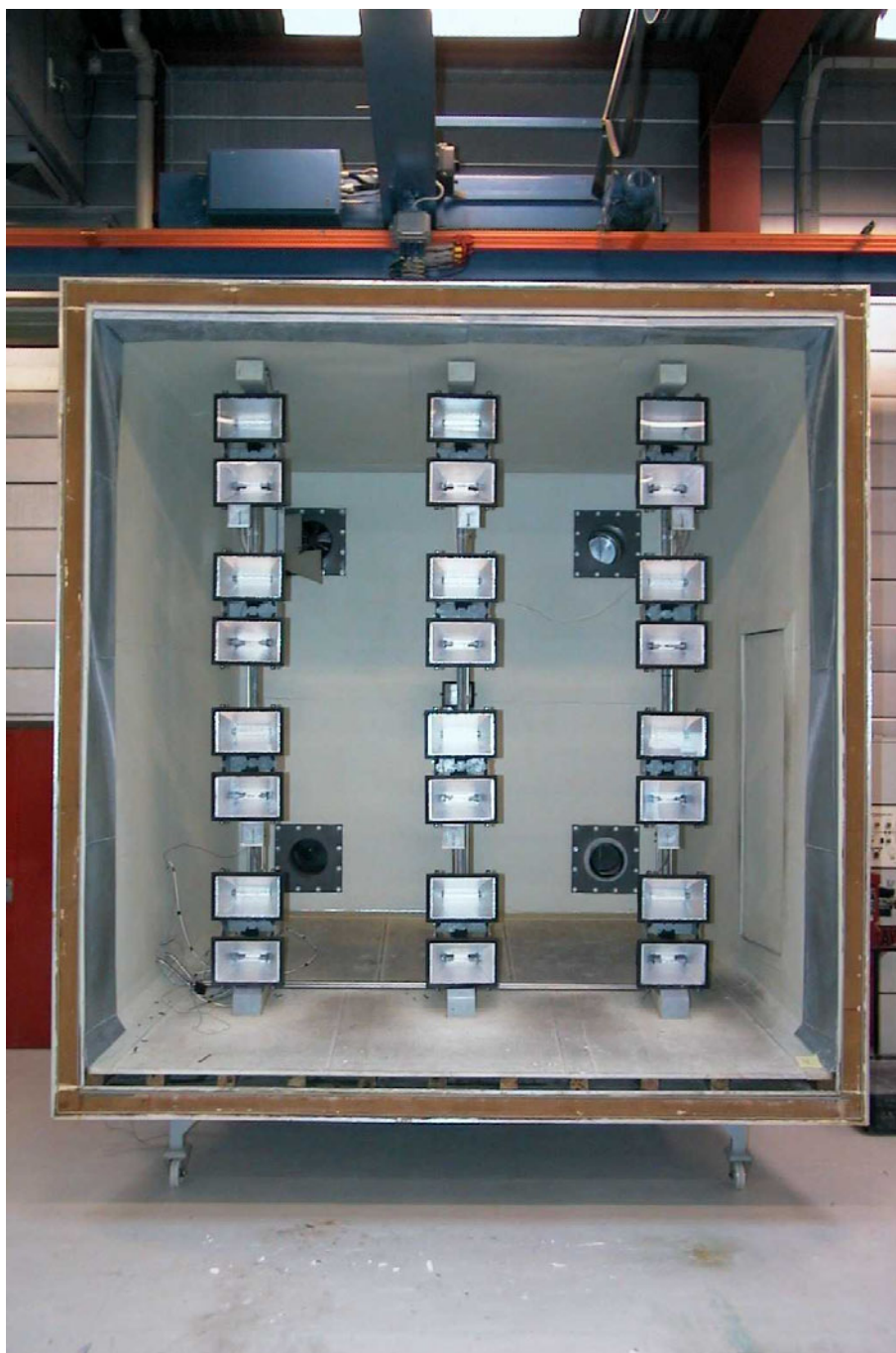
Figur 8. Foto af udeklimakassen set fra prøvefeltet. Lamperne er monteret på tre stålsøjler med en indbyrdes afstand på 1 m. På hver søjle er monteret fire sæt lamper, hver bestående af en metalhalogenlampe til UV-bestråling og en halogenglødelampe til varmebestråling, med en indbyrdes lodret afstand på 0,75 m mellem sættene. På hver søjle er yderligere monteret to vanddyser med skærm og drypfang til beskyttelse af lampeglassene mod vandstænk. Af bagvæggens fire ventilationsåbninger benyttes de tre til cirkulation af kold luft eller luft fra forsøgshallen. Den øverste åbning til venstre er forsynet med irisblænde til regulering af luftmængde og -tryk og preplade til dirigering af indblæsningsluften.
