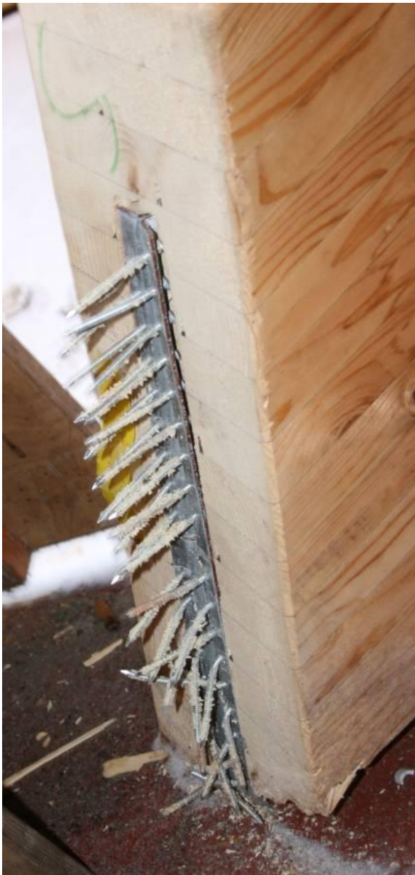
Billede A7. Den nedfaldne ås (faldet ned på hovedet).
