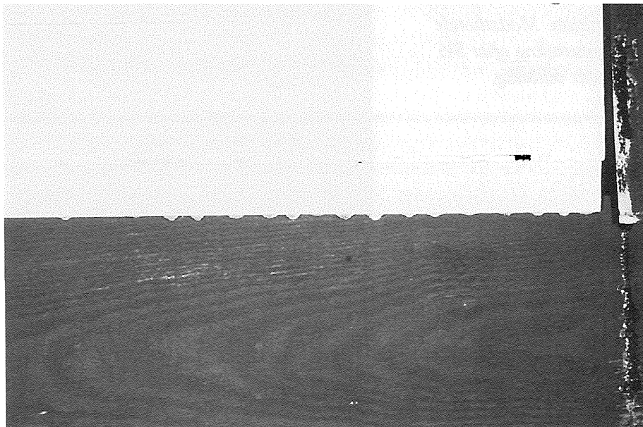
Figur 29. "De fire årstider": Hjørnesamling af vindue efter 1 måneds ældning.
