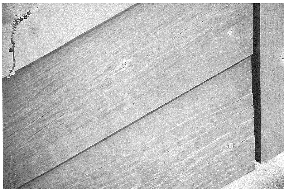
Figur 52. Den ny klima- simulator: Midtersamling efter 2½ måneds ældning.
