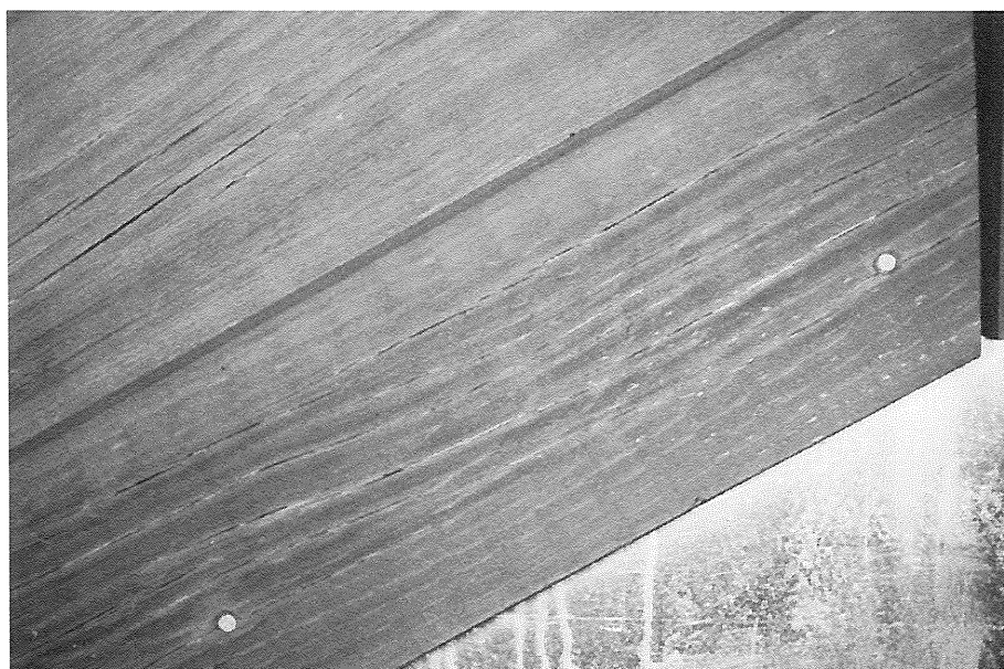
Figur 53. Den ny klima- simulator: Midtersamling efter knap 7 måneders ældning.
