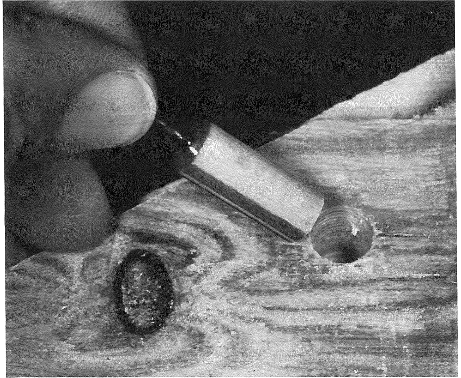
Figur 9. Prøveemne: Indboring af fugtmåledyvel.
