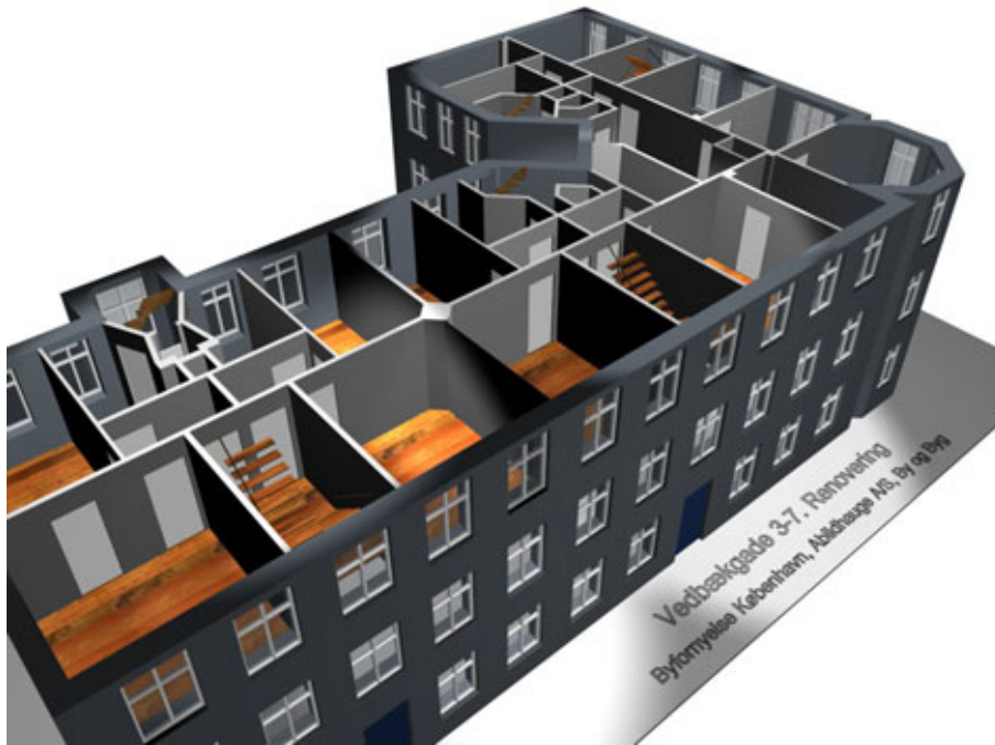
Figur 57. Den digitale model har ikke samme begrænsninger som tegningen, idet den både er målfast og perspektivisk, derudover kan den animeres, underlægges stereovirkninger etc. Illustration fra renoveringssag "Vedbæksgade". (Illustration: By og Byg).
