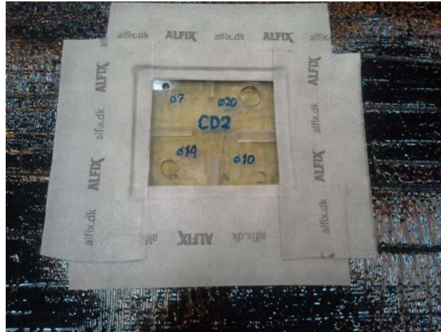
Figur 6. Blændeskive placeret i prøvestandens øvre membran. De enkelte huller kan blændes med tape, hvorved forskellige kombinationer af åbninger kan etableres.
