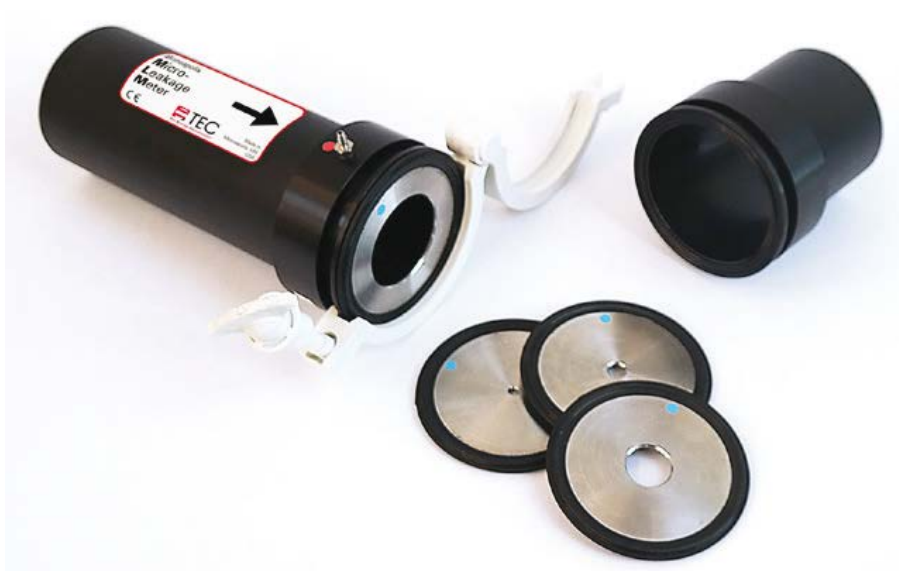
Figur 5. Enhed til bestemmelsen af luftstrømmen der pumpes ud af prøvevolumenet. Luftstrømmen over blænden måles.
