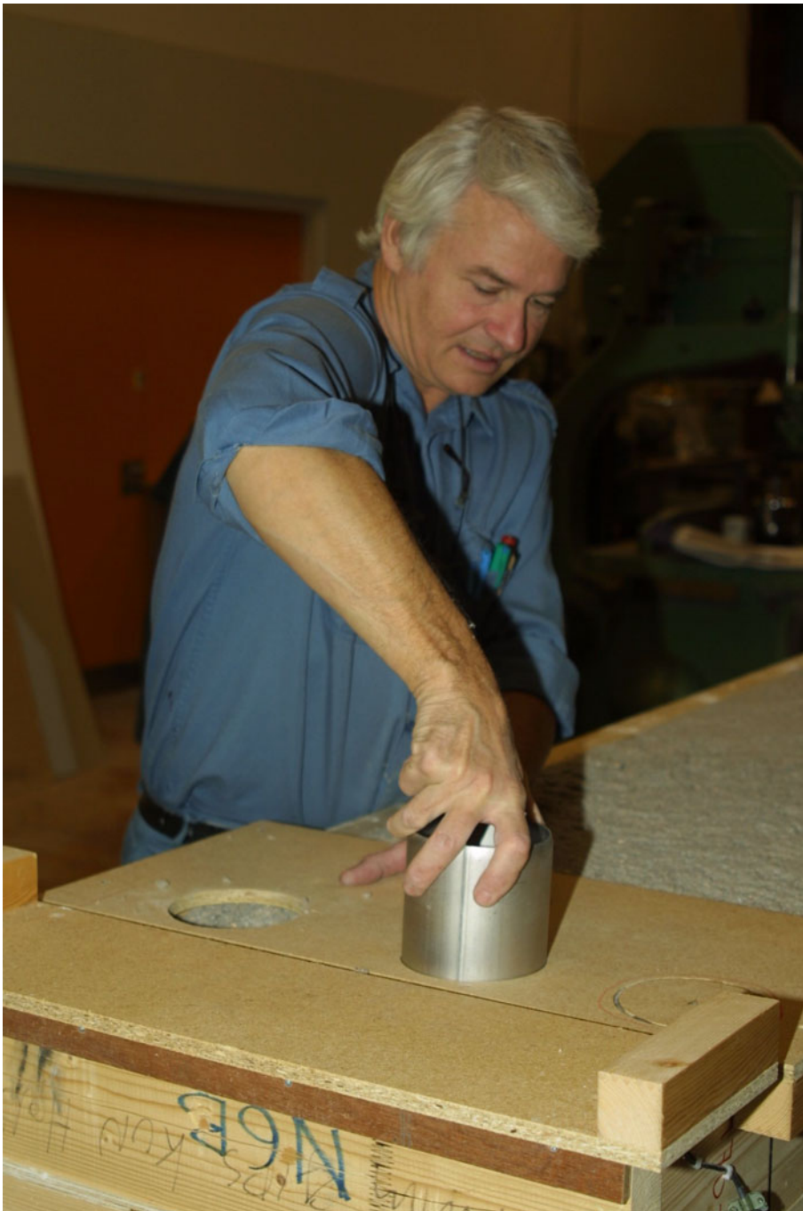
Figur 12. Af den indblæste isolering udtages prøver til bestemmelse af densiteten på forudbestemte steder. Prøverne udtages ved at føre et rør gennem papirulden. Røret er slebet skarpt, således at det med lethed kan skære sig gennem papirulden ved håndkraft. Papirulden fastholdes i den umiddelbare nærhed af stedet for densitetsprøven af en spånplade. Spånpladen tjener ligeledes som styr for røret til prøveudtagningen.
