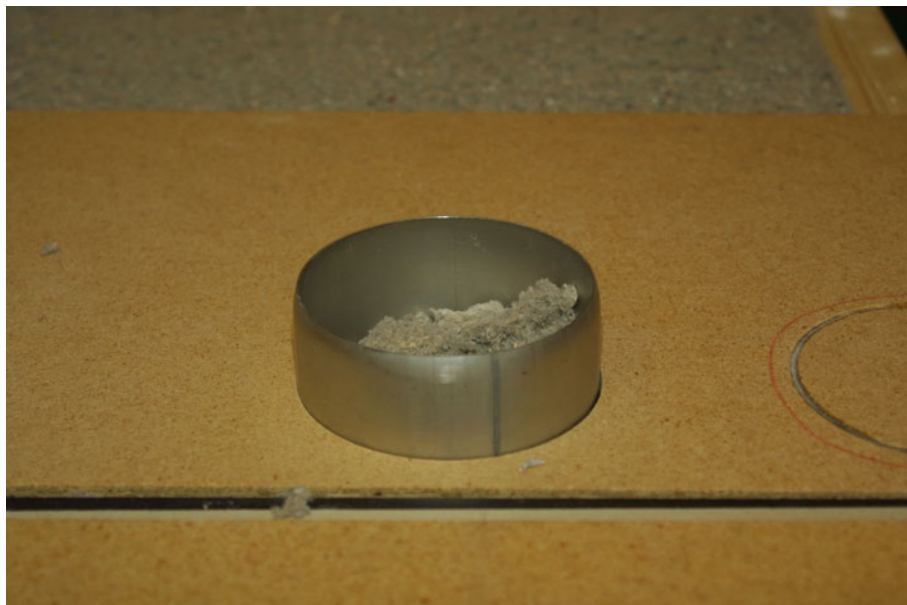
Figur 13. Røret, til at udtage den lokale densitetsprøve med, føres hele vejen gennem papirulden før prøven udtages. Papirulden fastholdes, i den umiddelbare nærhed af stedet for densitetsprøven af en spånplade. Spånpladen tjener ligeledes det formål at være styr for røret til prøveudtagningen.
