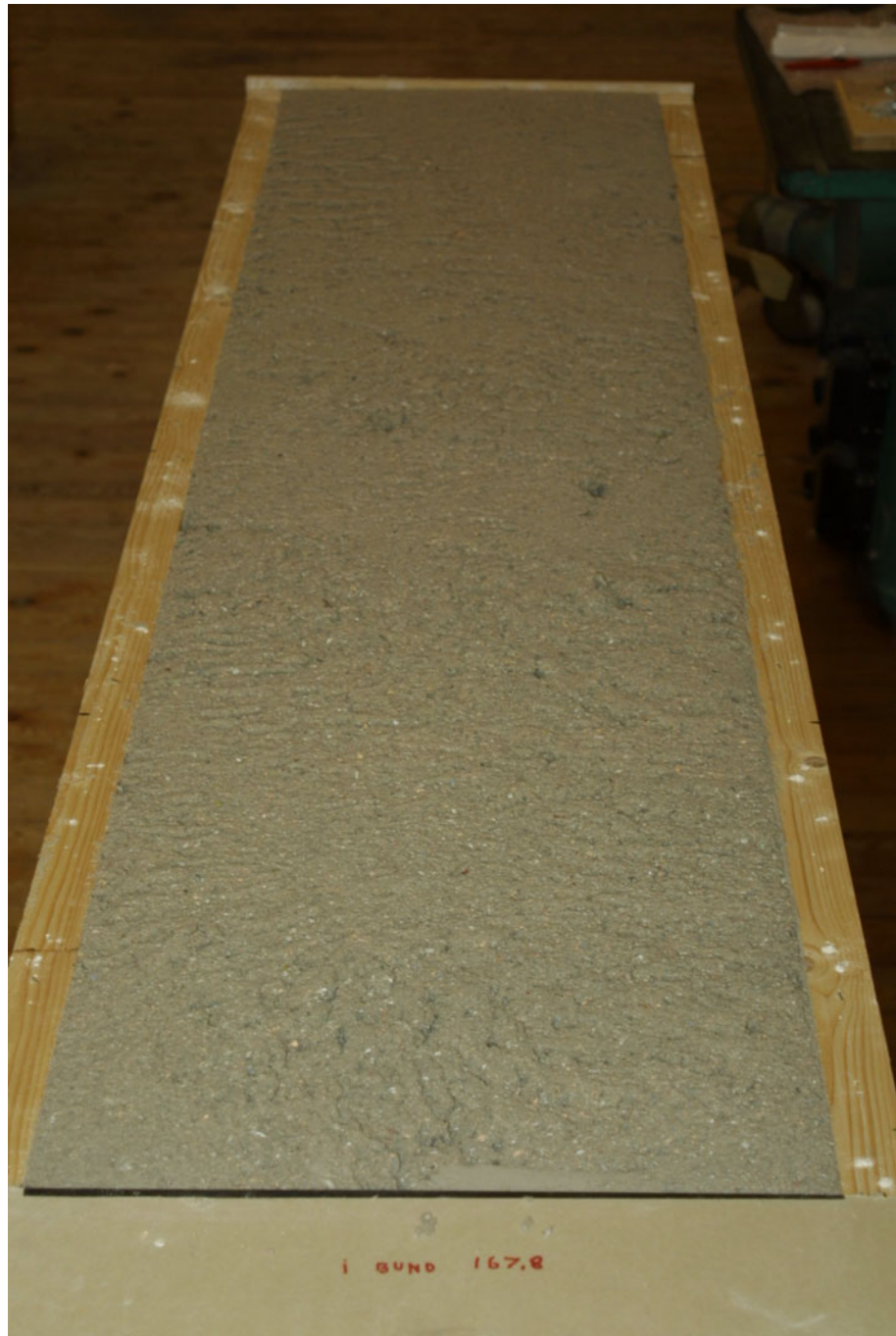
Figur 11. Efter vejning lægges væggen ned og gipspladen, som udgør en af væggens sider, afmonteres således, at den indblæste Papiruld kan inspiceres.
