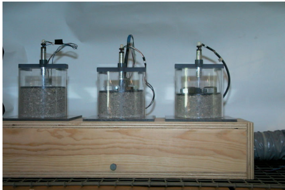
Figur 2. Apparatur til måling af krybningen ved cyklisk varierende relativ luftfugtighed. I det viste tilfælde er Ekofiber med en densitet på 50 \text{ kg/m}^3 påsat en vertikal belastning på henholdsvis (63,12 + 20) , (135,32 + 20) og (285,45 + 20) Pa. Den vertikale last på oversiden af isoleringen er etableret med lodder, og undertrykket på undersiden af isoleringen er 20 Pa.
