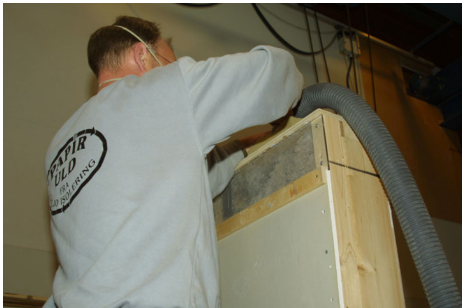
Figur 8. Indblæsning af Papiruld i en væg beklædt med gipsplade. På den ene side af væggen er de øverste 15 cm af beklædningen, erstattet af en plexiglasplade. Gennem plexiglaspladen kan indblæsningen af papirulden følges. Papirulden ses gennem plexiglaspladen som et gråt materiale. I det viste tilfælde indblæses løsfyldsisoleringen i en væg med de indvendige dimensioner: længde \times tykkelse \times højde lig med 0,495 m \times 0,198 m \times 2,3 m uden lægter.
